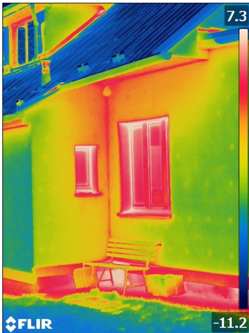
Obrázek č. 5 – Ukázka lineárních a bodových tepelných mostů, zdroj: autorka DP
