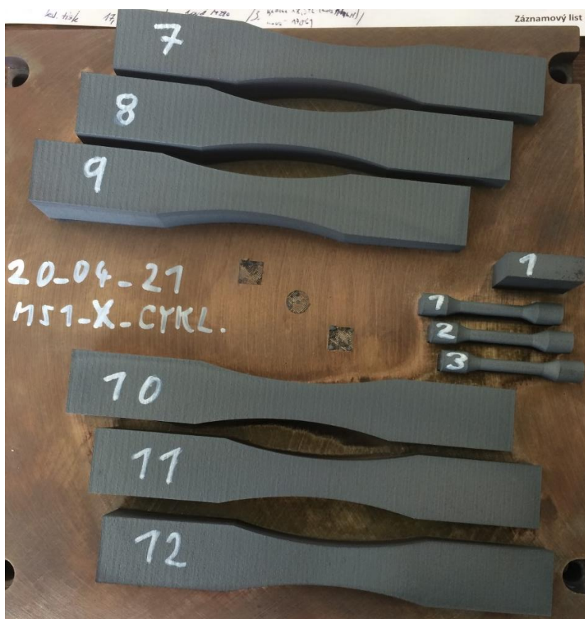
Obrázek 38 - Vytíštěná tělesa na platformě pro cyklickou a tahovou zkoušku
