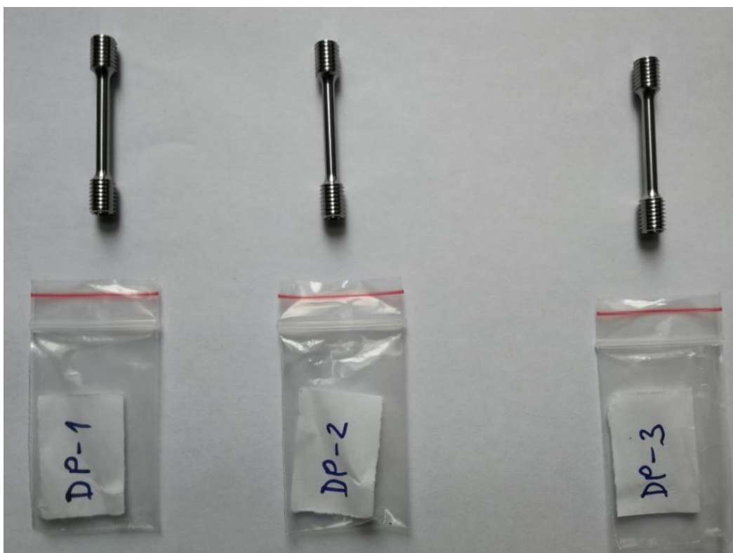
Obrázek 40 - Zkušební tělesa pro tahovou zkoušku
