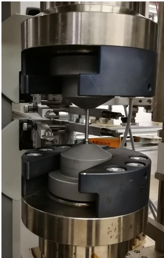
Obrázek 41 - Zkouška tahem (upnutí zkušebního vzorku)
