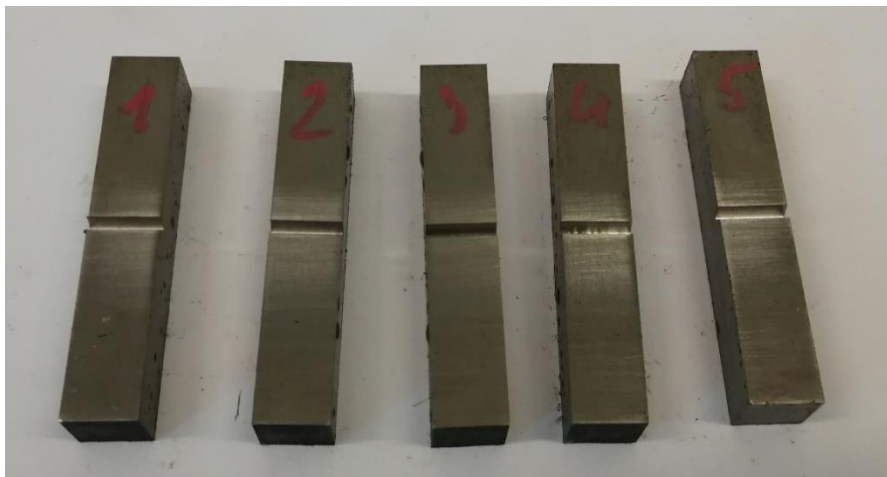
Obrázek 45 - Zkušební tělesa pro zkoušku rázem v ohybu
