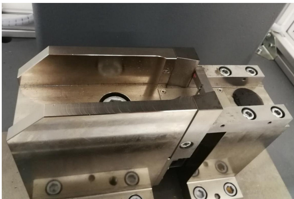
Obrázek 46 - Uložený vzorek pro zkoušku rázem v ohybu
