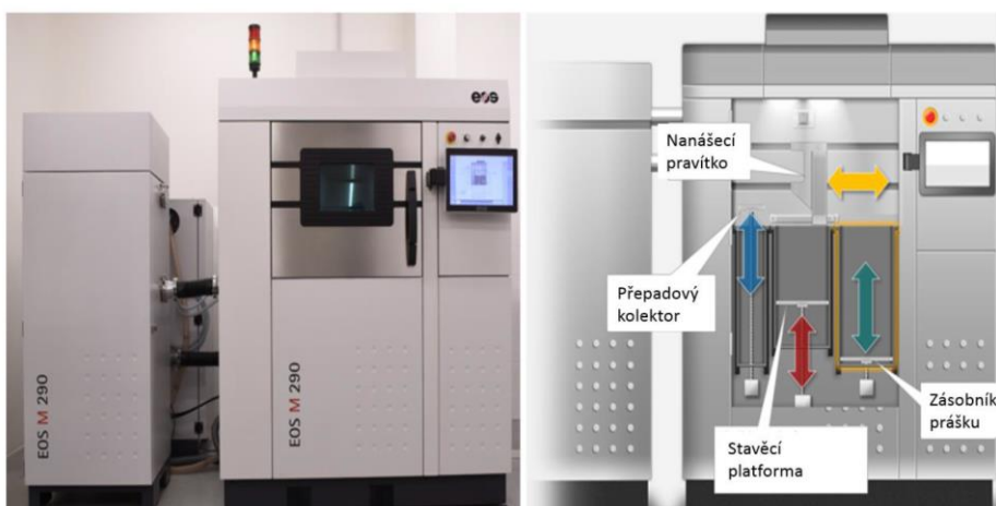
Obrázek 26 - Stroj EOS M 290 a jeho vnitřní složení [1]
