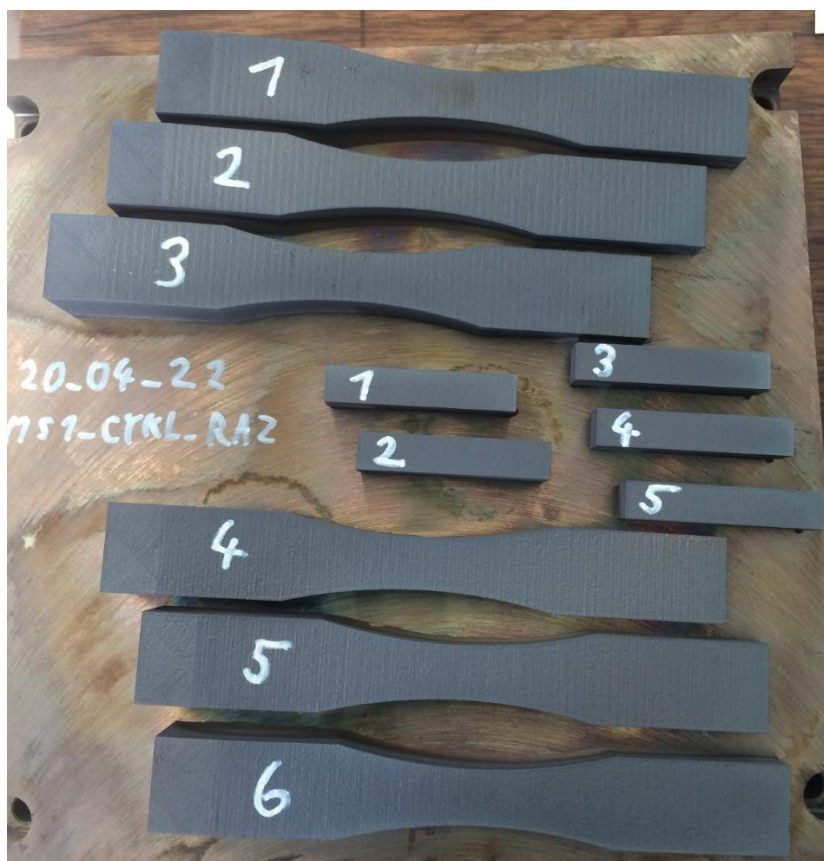
Obrázek 37 - Vytíštěná tělesa na platformě pro cyklickou zkoušku a zkoušku rázem v ohybu
