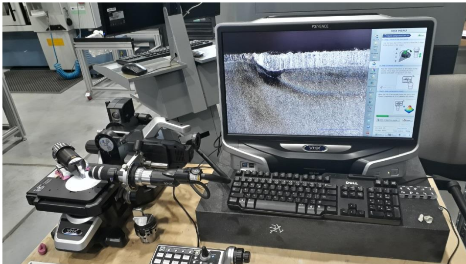
Obrázek 31 – optický mikroskop Keyence VHX 6000 používaný pro zjišťování hodnot
