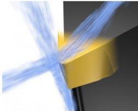
Obrázek 5 – kombinovaný přívod řezné kapaliny [3]
