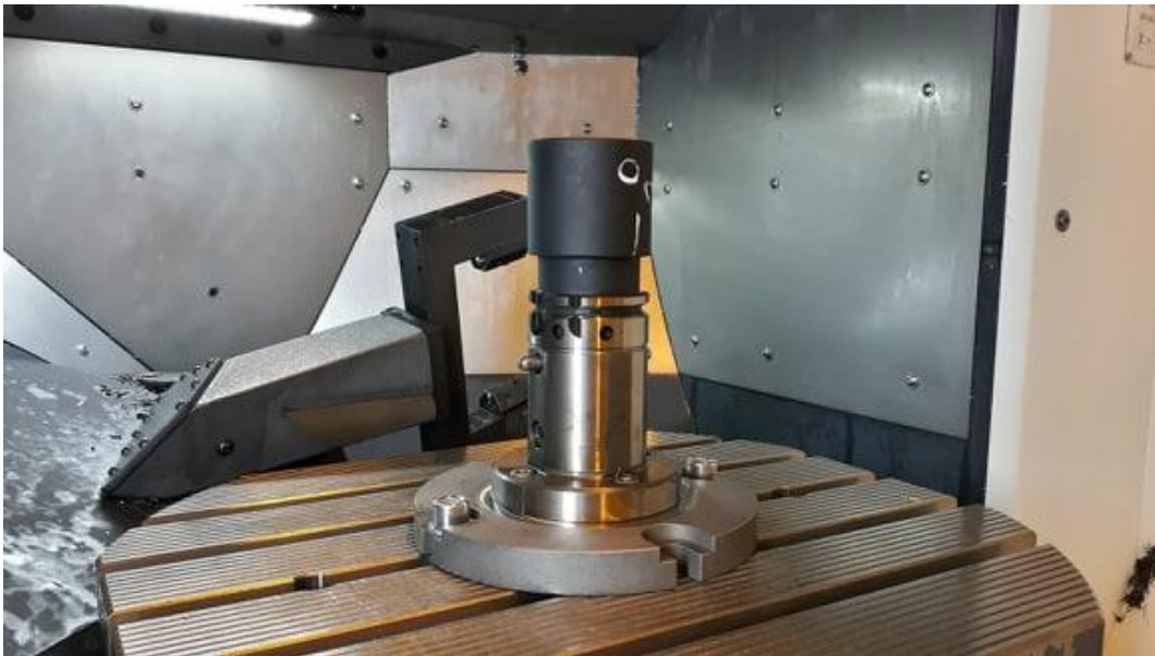
Obrázek 23 – připravený polotovar na výrobu nástroje upevněný v prostorách frézky
