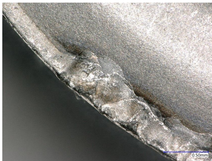
Obrázek 40 – destrukce břitu vzniklá při hledání horní úrovně řezné rychlosti
