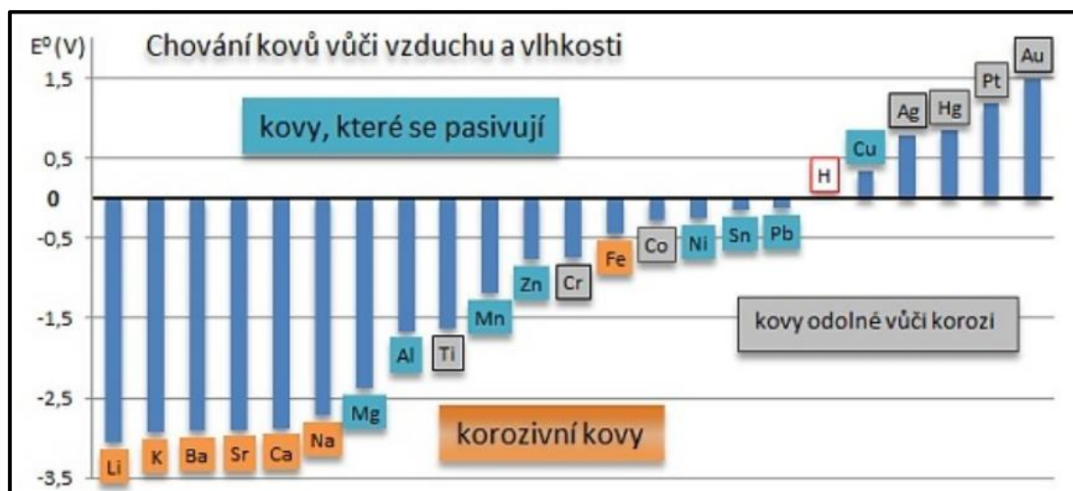
Obr. č. 67: Zredukovávaná Beketovova řada kovů v závislosti na elektrodovém potenciálu (pod hodnotou 0 jsou to kovy neušlechtilé se záporným elektrodovým potenciálem a nad 0 jsou to kovy ušlechtilé s kladným elektrodovým potenciálem). [75]
