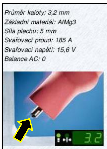
Obr. č. 29: Vliv excentricity a geometrie špičky [6]
