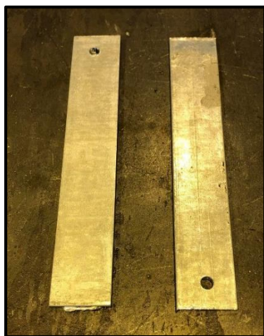
Obr. č. 76: Materiál poskytnutý od společnosti ABADIA, a.s., tloušťka 5 mm, šířka 40 mm a délka 225 mm
