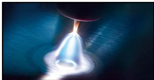
Obr. č. 6: Tvar volně hořícího oblouku svařovací metody TIG [11]
