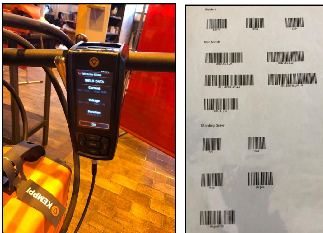
Obr. č. 80 : Monitorovací a čtecí zařízení značky Kempppi vlevo a vpravo papír pro načtení svař. informací (svářečcí personál, přídavný materiál, ochranný plyn atd.)
