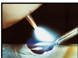
Obr. č. 15: Svařování metodou TIG v ochranném plynu [10]
