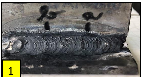
Obr. č. 71: TIG – svařový spoj, Ø2 W3Si1
