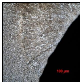
Obr. č. 90: Mikrostruktura ve 2/3 MIG svarového spoje zkušební kusu č. 3 (500 x zvětšení vlevo a vpravo 1000 x zvětšení), foceno uvnitř svaru, „černé ostrůvky“ jsou perlit a „bílá zrna“ jsou ferit alfa, nejmenší „černé tečky“ uvnitř feritického zrna jsou s největší pravděpodobností nečistoty ve formě oxidů
