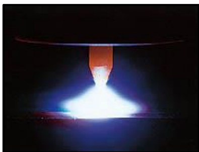
Obr. č. 5: Svařování metodou TIG v ochranném plynu (viditelné zvonovité rozšíření oblouku) [10]
