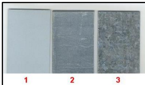
Obr. č. 64: Způsoby zinkování materiálů (1 - galvanicky zinkováno, 2 - naválcovaná vrstva zinku, 3 - žárově zinkováno ponorem) [64], [65]
