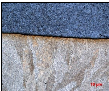
Obr. č. 101: Rozhraní svarový spoj – základní materiál (zvětšení 100 x)
