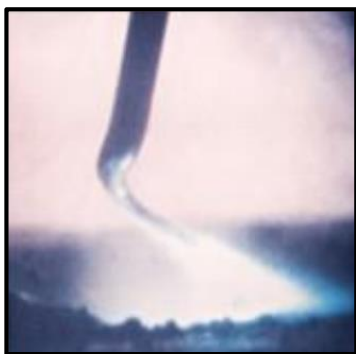
Obr. č. 54: Rotující oblouk [56]
