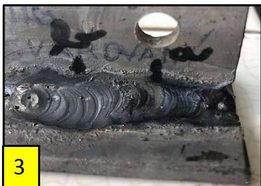
Obr. č. 73: MIG – svařový spoj, Ø1 G3Si1
