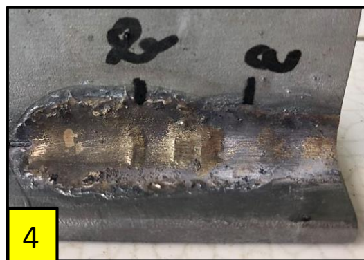
Obr. č. 74: TIG – pájený spoj, Ø1,5 20 % Ag
