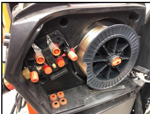
Obr. č. 43: Kompletní skříň s cívkou, podavačem a pájecím drátem CuSi3 ve společnosti ARC-H a.s., foceno autorem DP při experimentu
