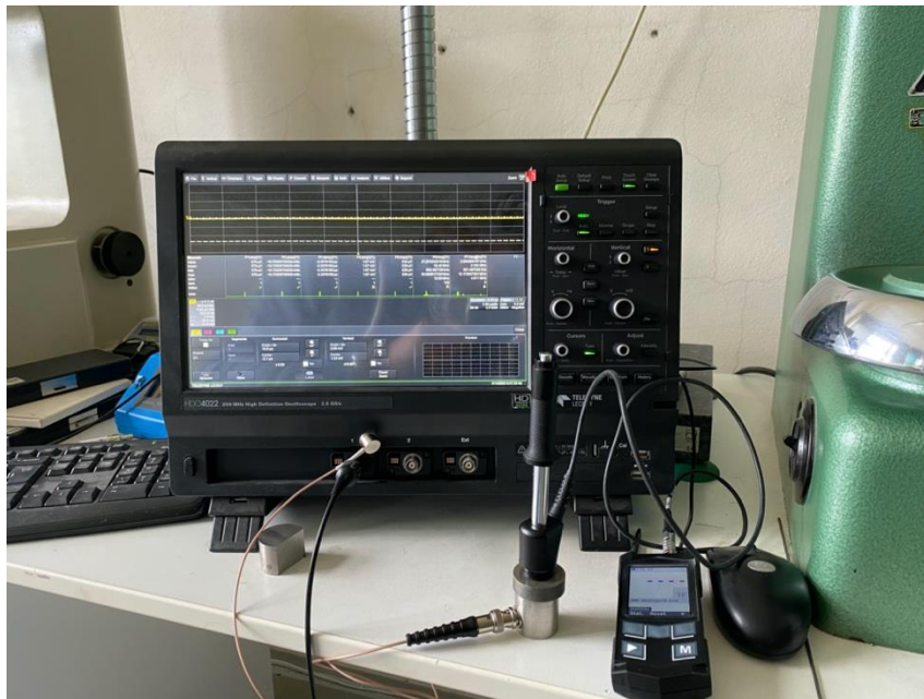
Obr. 36 Konfigurace měření ultrazvukových vlastností vzorků metodou akustické emise
