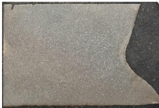
Obr. 64 Makrostruktura řezu z počátku válcované tyče po válcování.
