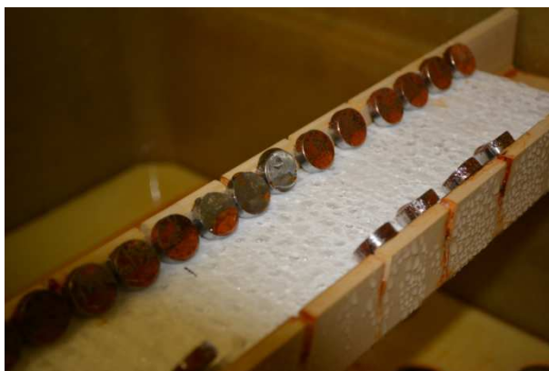
Obrázek 24: vzorky v korozní komoře
