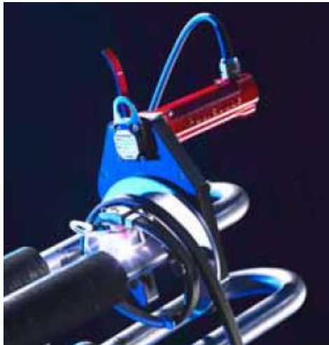
Obrázek 8: Otevřená svařovací U – hlavice Polysoude pro orbitální svařování [9].
