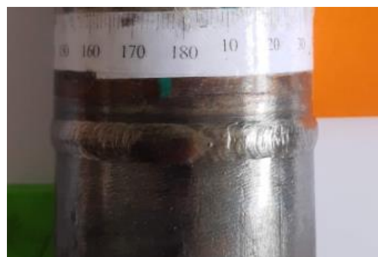
Obrázek 39 : Místa odběru vzorků k metalografii (vlevo) a zakončení svaru vpravo.
