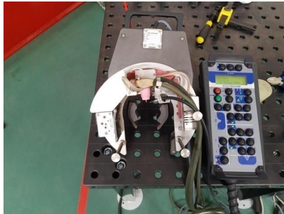
Obrázek 22 : Otevřená svařovací hlava s dálkovým ovladačem.
