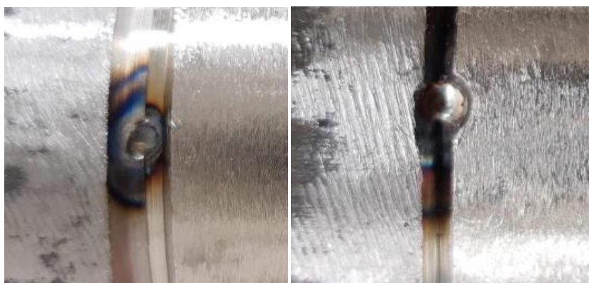
Obrázek 49: Porovnání stehu úkosu U (vlevo) a V (vpravo).
