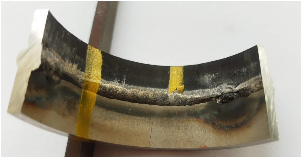
Obrázek 36: Studený spoj na místě původního stehu – svařenec V0_5 (steh v poloze 50).
