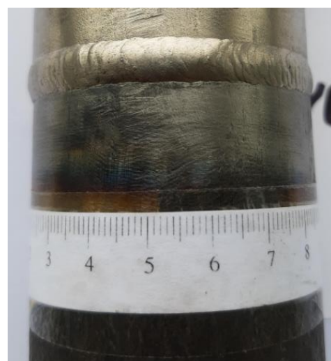
Obrázek 37: Návrh umístění stehů k eliminaci vad (vlevo), čísla označují přibližnou polohu v mm podle umístěného měřítka (vpravo).
