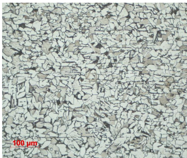
Obrázek 19: Feriticko-perlitická struktura ZM P265GH, normalizačně válcováno.
