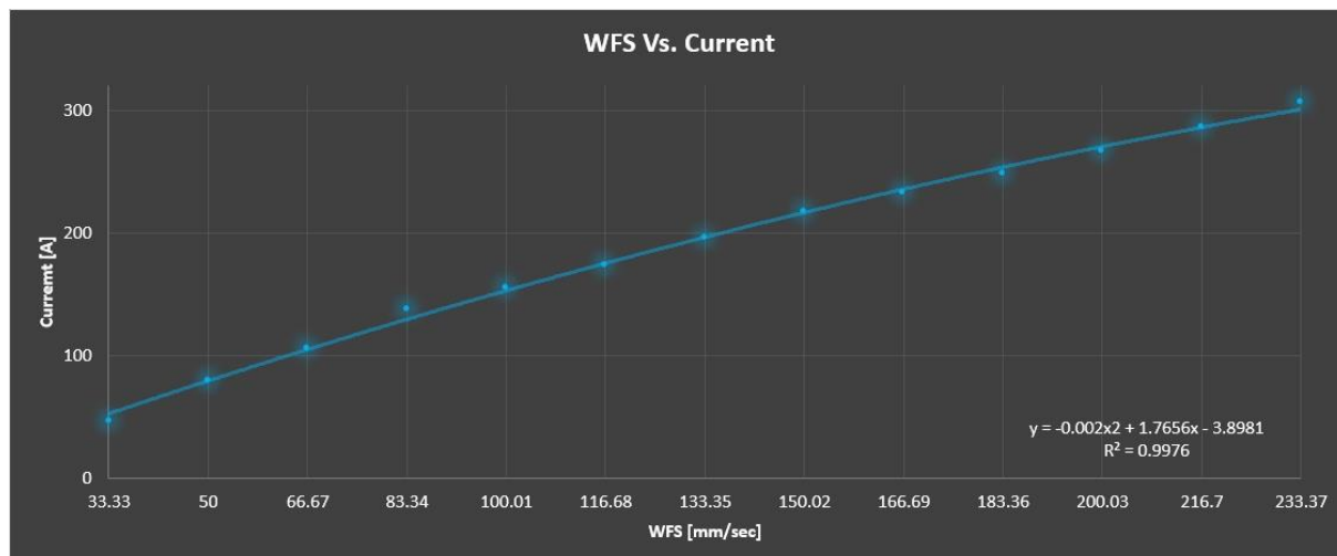
Obr. 28 Závislost WFS – elektrický proud (RapidArc, 90%Ar 10%CO 2 , výlet drátu 15 mm)
