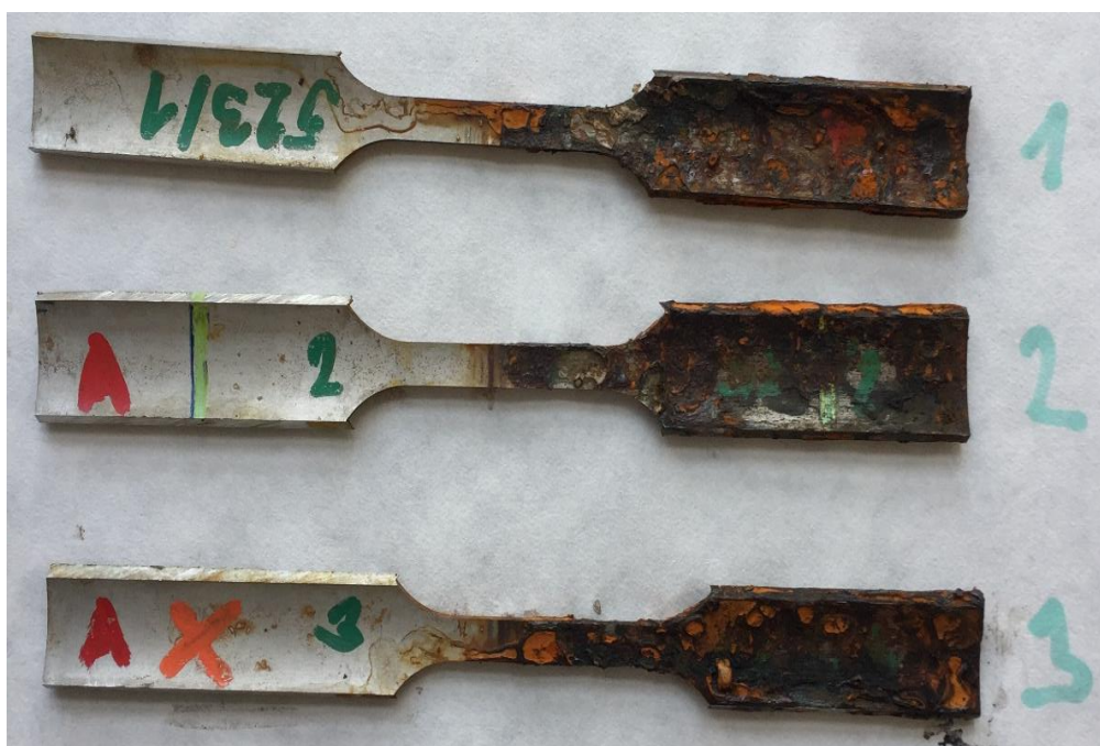
Obr. 27. Vzorky 523 bez předepnutí po ukončení korozního testování
