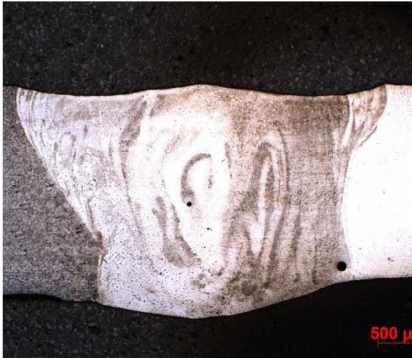
Obr. 39. Svarový kov vzorku 523/3 C – zvětšeno 25x, póry, segregační pásma
