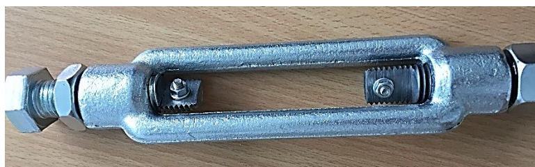
Obr. 19. Přípravek napínací matice pro vyvolání tahového napětí
