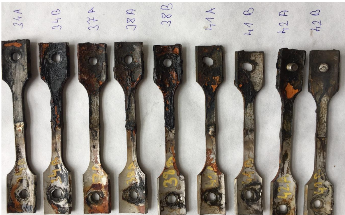
Obr. 28. Vzorky svařované metodou 141 s aplikovaným předepnutím po ukončení korozního testování a odejmutí z přípravku
