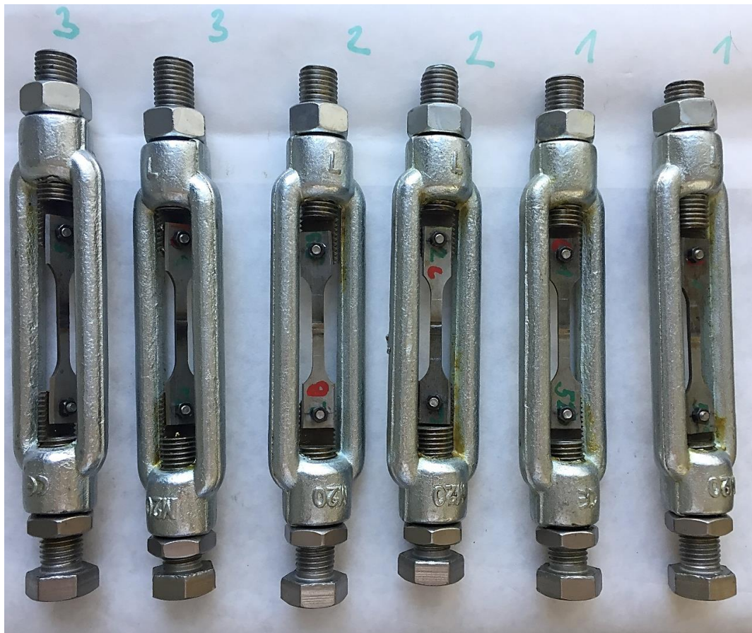
Obr. 22. Předepnuté vzorky 523 před umístěním do korozní komory
