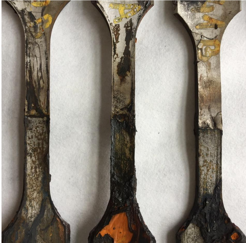
Obr. 52. Detail vzorků svařovaných metodou 141 po expozici v solné mlze (235 hodin)
