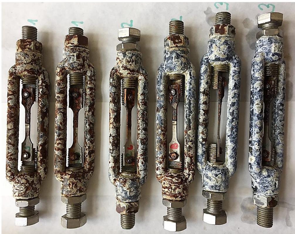
Obr. 25. Předepnuté vzorky (523) v přípravcích po ukončení testu
