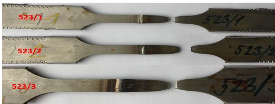
Obr. 20. Příčná zkouška tahem (vlevo materiál 1.4541, vpravo P265GH)
