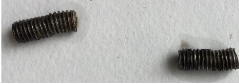
Obr. 30. Usmýknuté šrouby M5 pro uchycení vzorku do přípravku (po expozici)
