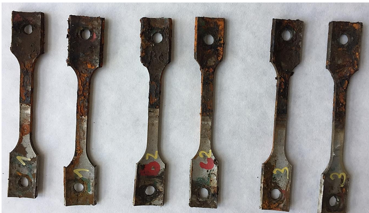
Obr. 26. Vyjmuté vzorky 523 z přípravků po ukončení korozního testování
