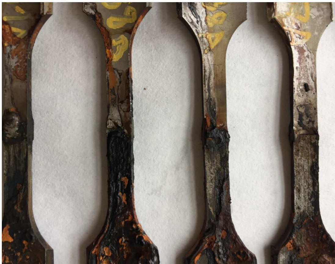
Obr. 51. Detail vzorků svařovaných metodou 141 po expozici v solné mlze (235 hodin)
