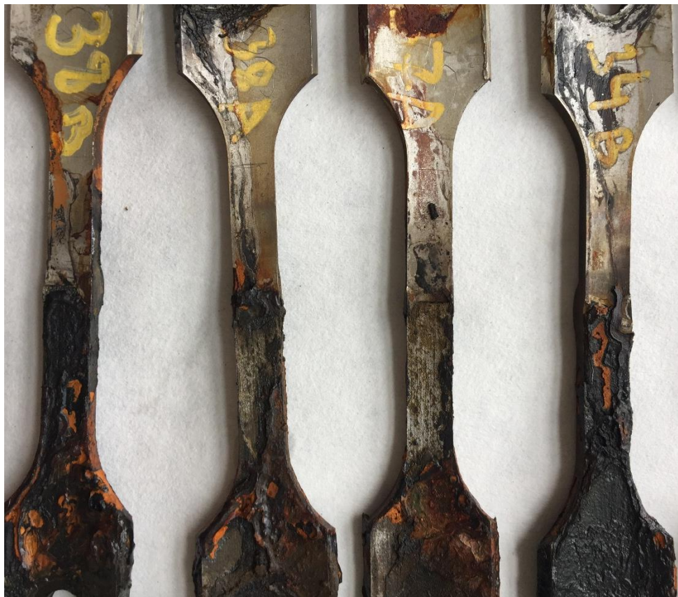
Obr. 53. Detail vzorků svařovaných metodou 141 po expozici v solné mlze (235 hodin)
