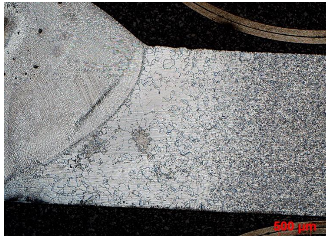
Obr. 46. vzorek 37C, zvětšeno 25x, přechod jemnozrnné oblasti v hrubozrnnou (ze strany ocelu 1.4541)
