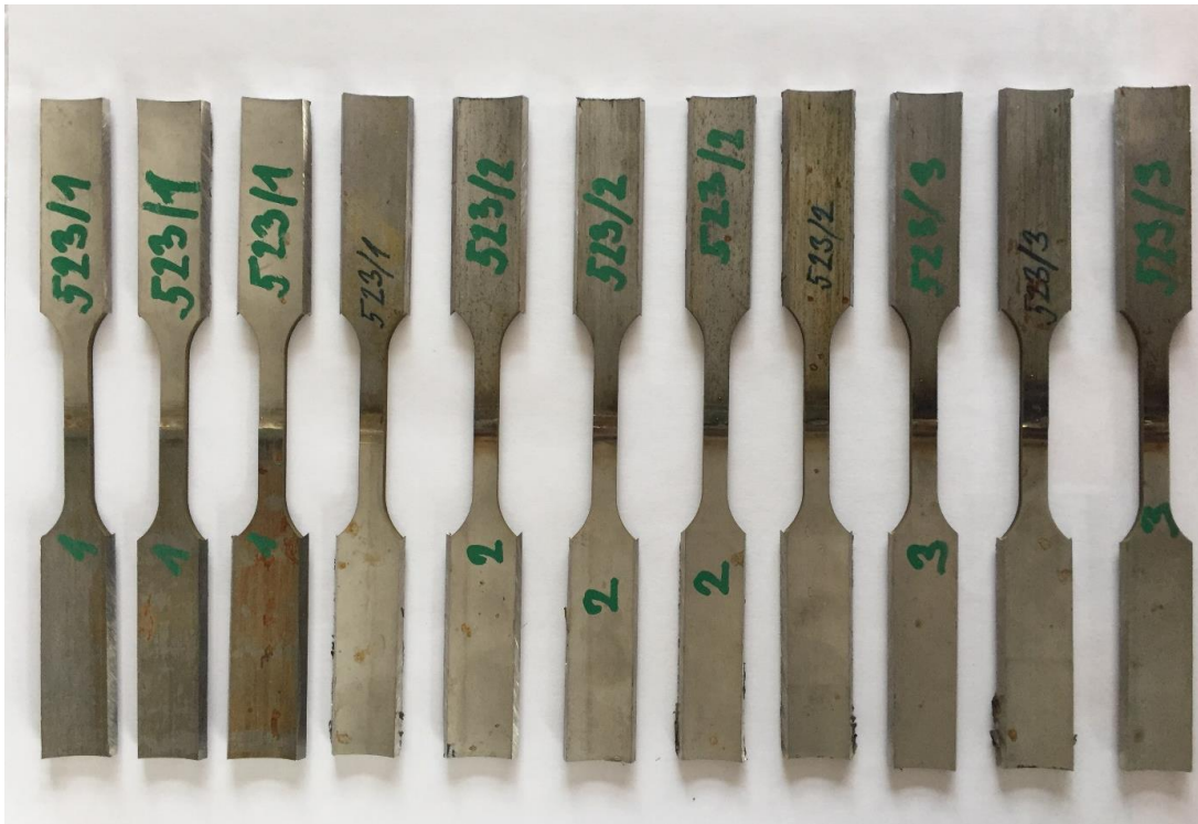
Obr. 17. Příprava vzorků (svařované metodou 521) pro testování. vzorky jsou nezkrácené a bez otvorů pro uchycení.
