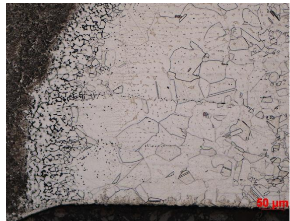
Obr. 42. Mikrostruktura vzorku 523/3 C1-ze strany ZM 1.4541, zvětšeno 200x, TOO, zhrubnutí zrna, dvojčatění, vměstky
