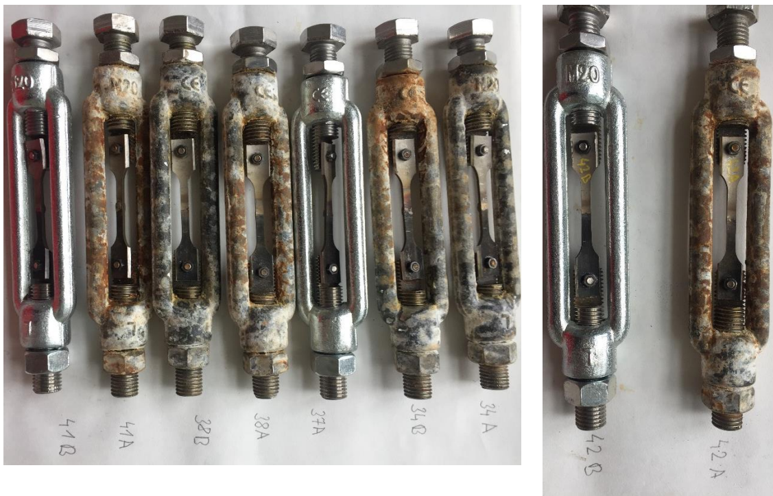
Obr. 23. Předepnuté vzorky 141 před umístěním do korozní komory
