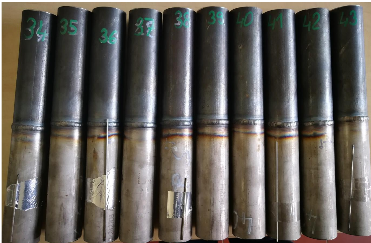
Obr. 14. Dodané trubky svařované metodou 141
