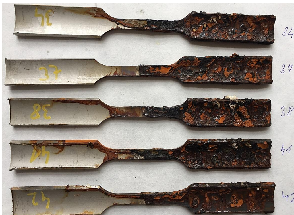
Obr. 29. Vzorky svařované metodou 141 s bez předepnutí po ukončení korozního testování
