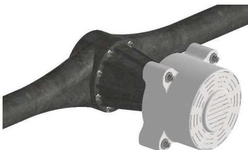
Obrázek 46 Spojení diferenciálu s motorem.
