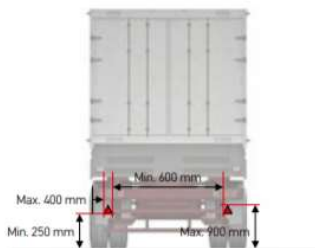
Obrázek 11 Umístění zadních odrazek[23]
