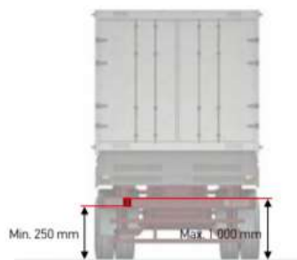
Obrázek 9 Umístění zadní mlhové svítilny[23]
