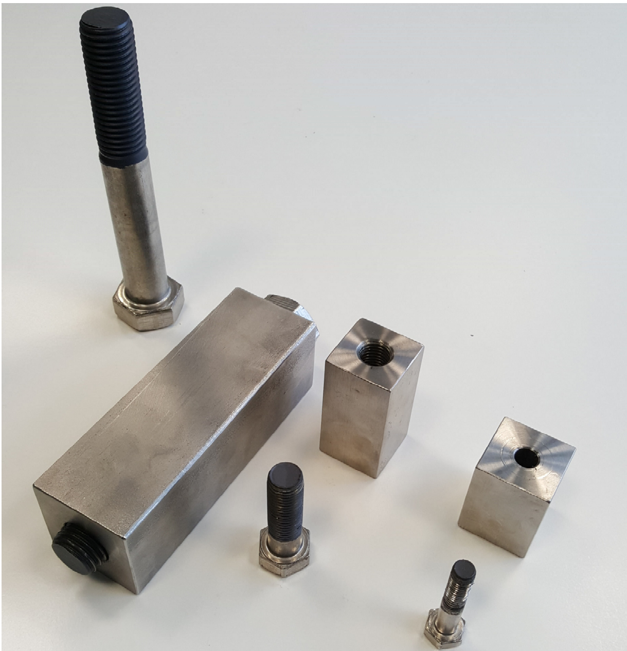
Obrázek 21: Test závitu s mazacím filmem
