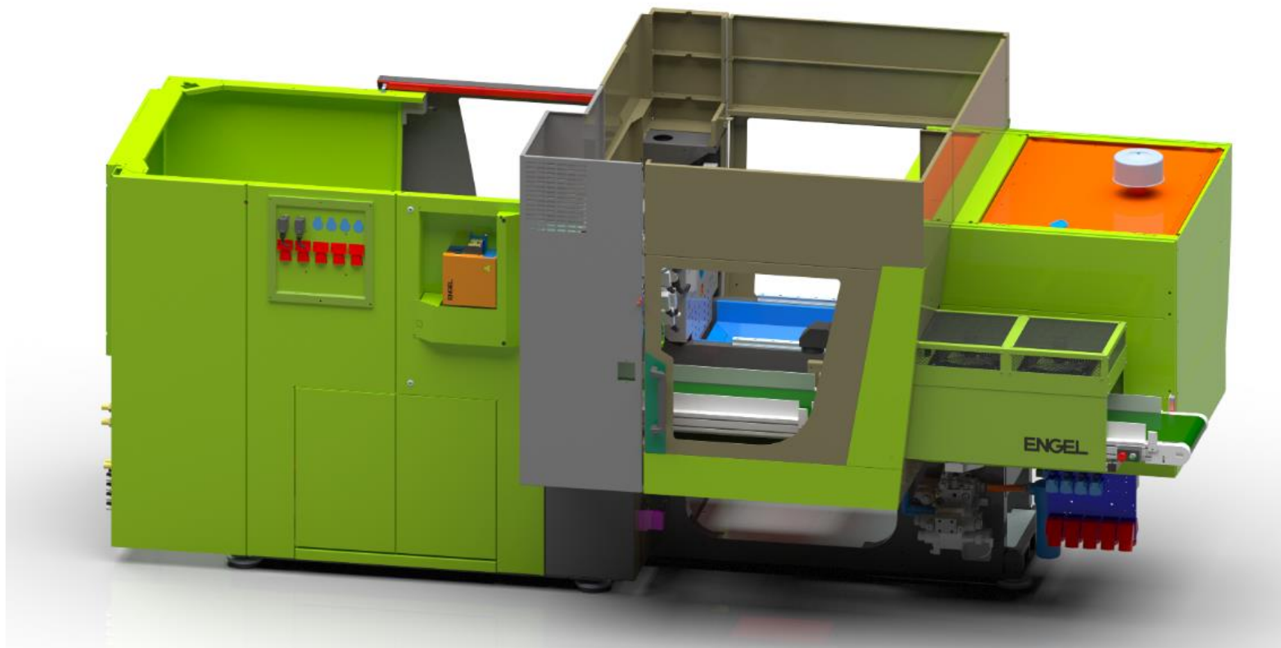
Obrázek 55 – Vstříkovací lis ENGEL VC 120 s integrovaným pásovým dopravníkem – 2. pohled
