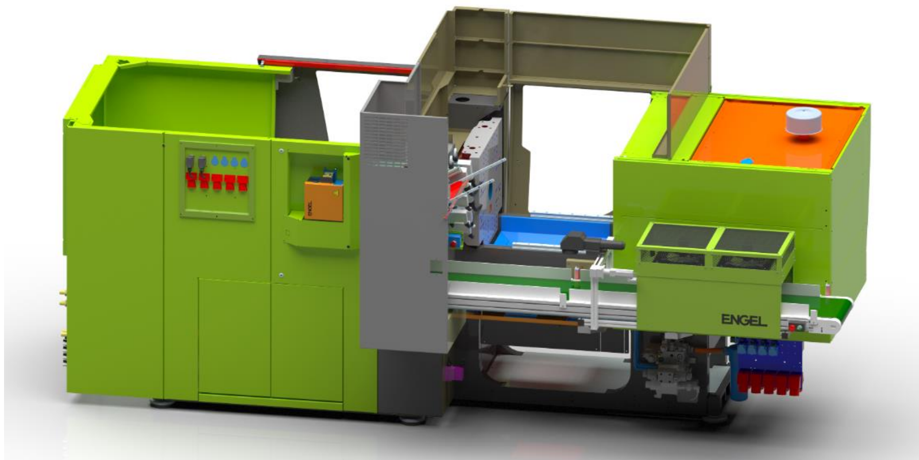
Obrázek 54 – Vstříkovací lis ENGEL VC 120 s integrovaným pásovým dopravníkem – 1. pohled
