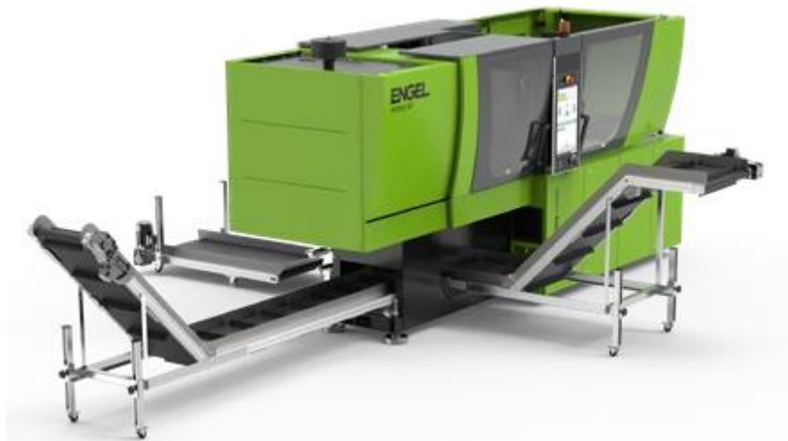
Obrázek 11 – Možné umístění dopravníkových systémů GFB, WFB a ZFB [12]
