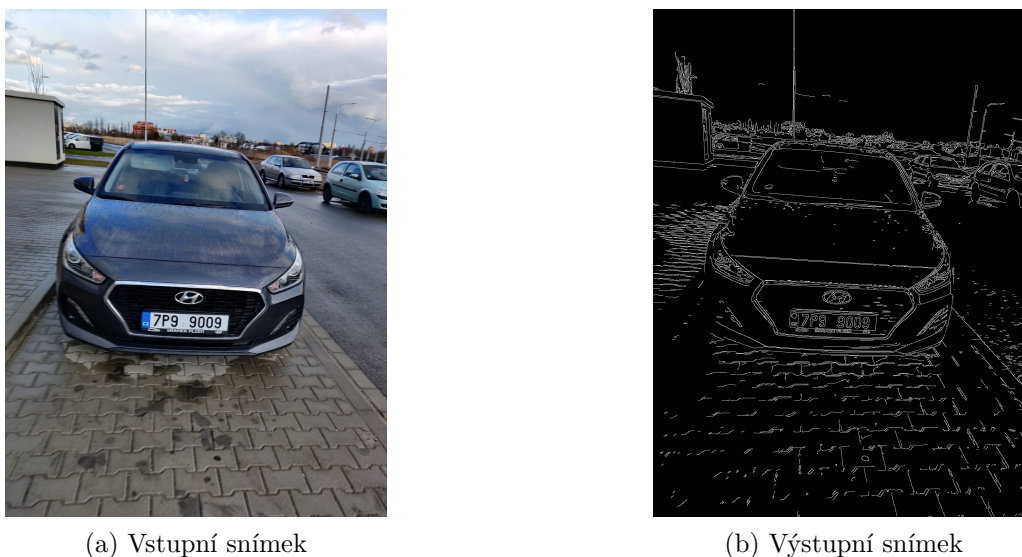
Obrázek 3.6: Ukázka aplikace Cannyho detektoru hran.
