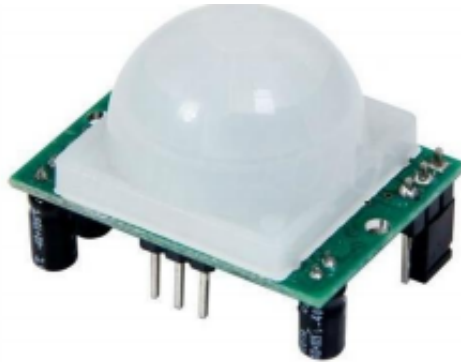
Obrázek 3.1: Modul pohybového senzoru, HC-SR501
