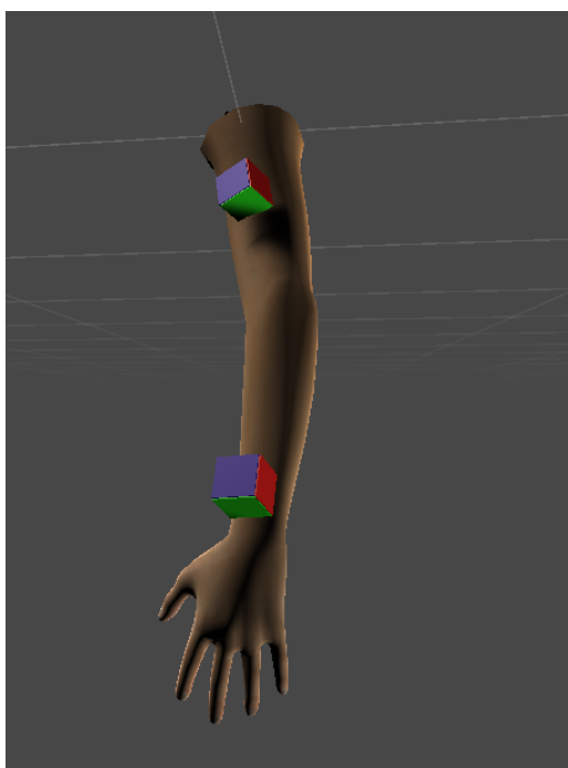
Obrázek 3.1: Umístění virtuálních trackerů na paži, zelená stěna objektu určuje směr osy y, modrá směr osy z a červená směr osy x
