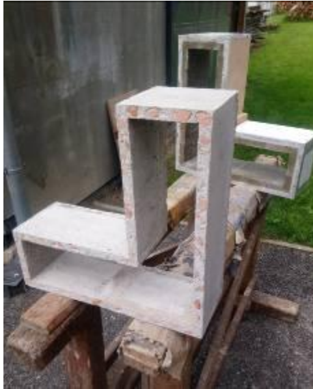
Obrázek 17 - první odlitek po obroušení s formou (archiv autora)
