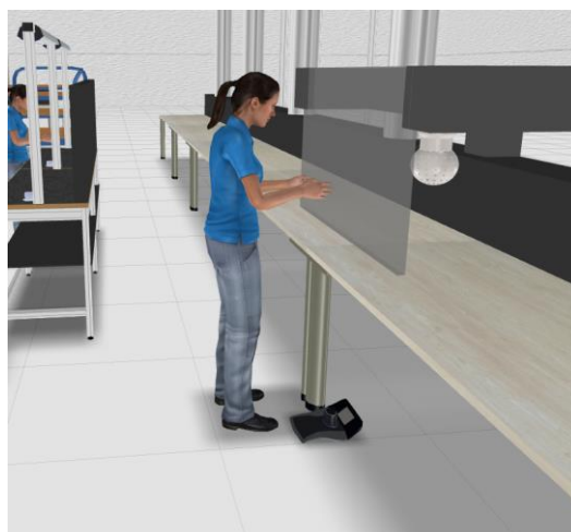
Obrázek 6 - Návrh nožního pedálu a nanášení lepidla pomocí trysky
