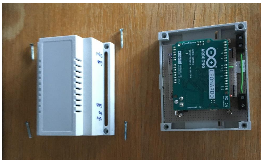
Obrázek 10 – Arduino umístěné v krabičce na lištu DIN [zdroj: autor]
