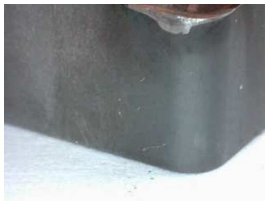
Obr. 39: Opotřebení na hřbetě
