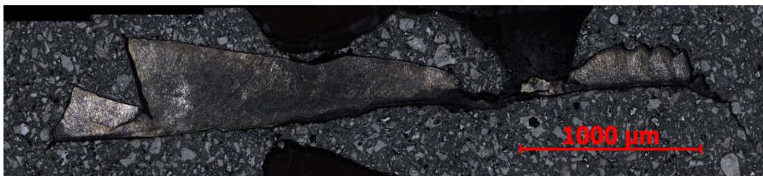
Obr. 45: Metalografický rozbor třísky vzniklé při obrábění kosočtvercovou destičkou
