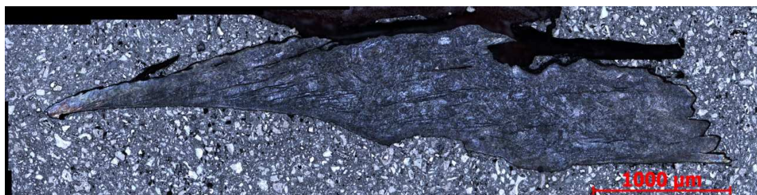
Obr. 47: Metalografický rozbor třísky vzniklé při obrábění čtvercovou destičkou
