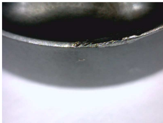
Obr. 43: Opotřebení na čele
