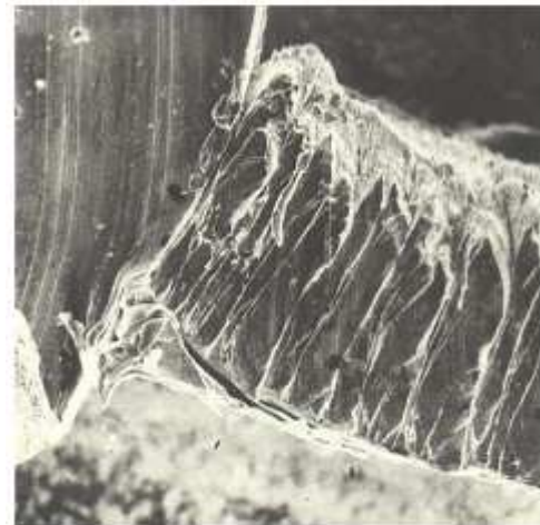
Obr. 6: Nárůstek u kořene třísky [7]
