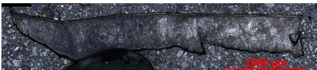
Obr.46: Metalografický rozbor třísky vzniklé při obrábění kruhovou destičkou
