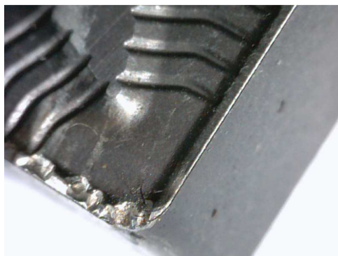
Obr. 38 : Opotřebení na čele
