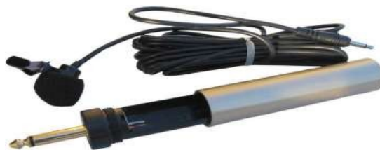
Obr. 3 Monofonní elektretový mikrofon Yoga EM-070
