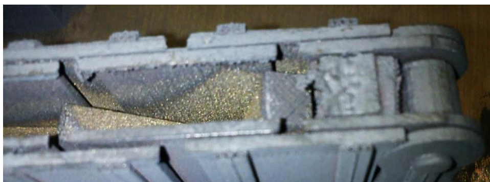
Obr. 27 Odlomení podpor v důsledku kontaktu s pravítkem
