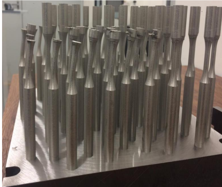
Obr. 28 Ohnutí tahových vzorků tvrdým nárazem s pravítkem
