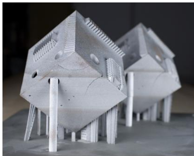
Obrázek 10 – Ukázka popraskání vlivem relaxace vnitřního pnutí [22]
