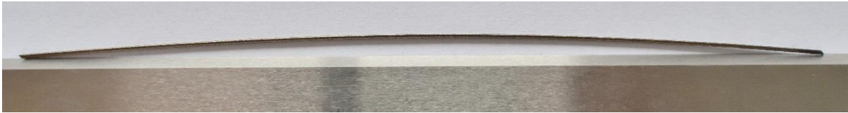
Obrázek 20 – Největší průhyb u žihaného prutu s \varnothing 0.86 mm, kontrola na průsvit
