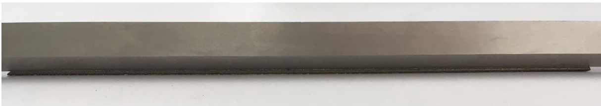
Obrázek 21 – Zbývající pruty jsou přímé, kontrola na průsvit
