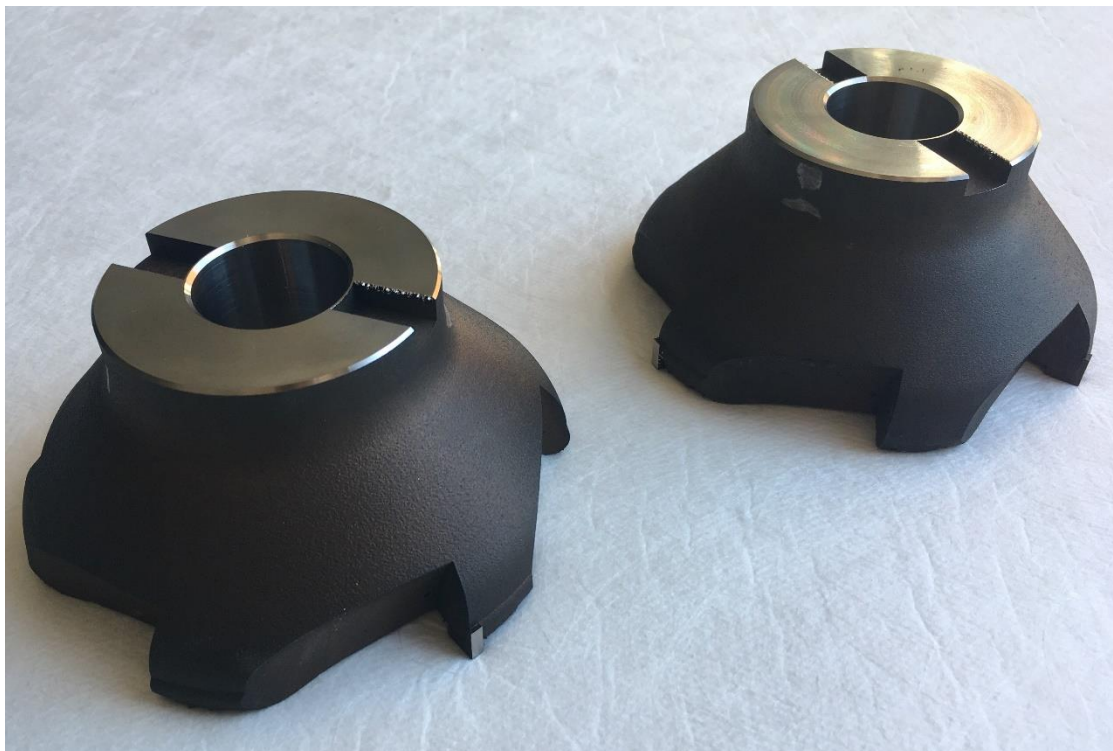
Obrázek 84 – Vytiskřený polotovar frézy ve variante 4A8 a 4C1
