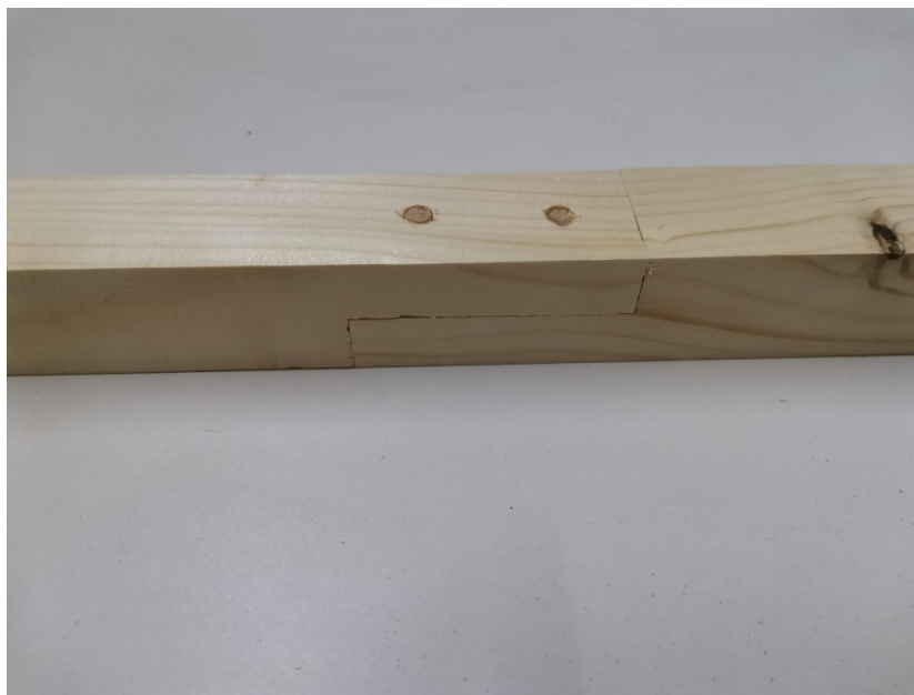
Obr. 18 – podélný spoj s dřevěnými kolíky [17]
