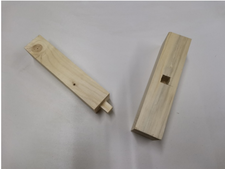
Obr. 21 – rozebraný čepový čtvercový spoj[17]
