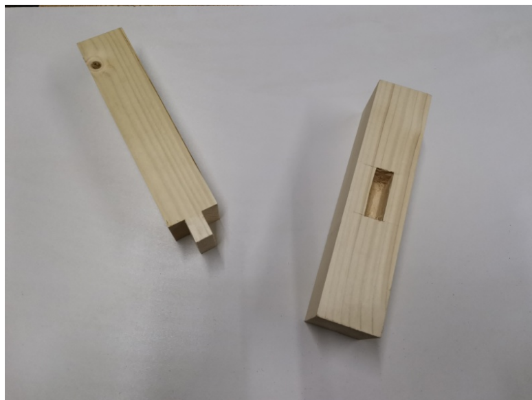
Obr. 22 – rozebraný čepový obdélníkový spoj[17]
