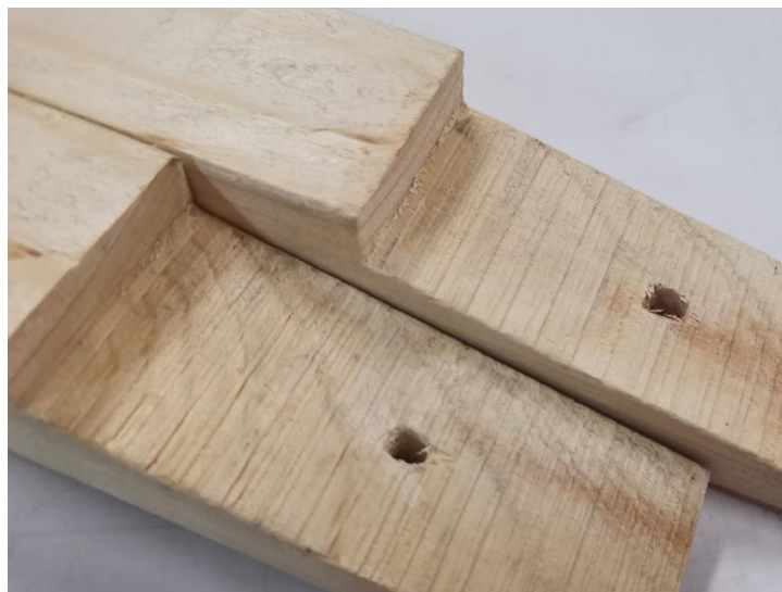
Obr. 37 – odskoky na plátech u vyřazeného vzoru 3.1 [17]
