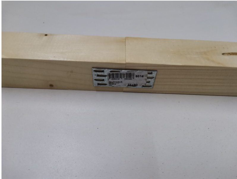
Obr. 19 – podélný spoj se styčnickovou deskou [17]
