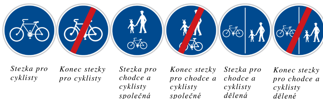
Obrázek č. 1: Dopravní značení v cyklistické infrastruktuře
