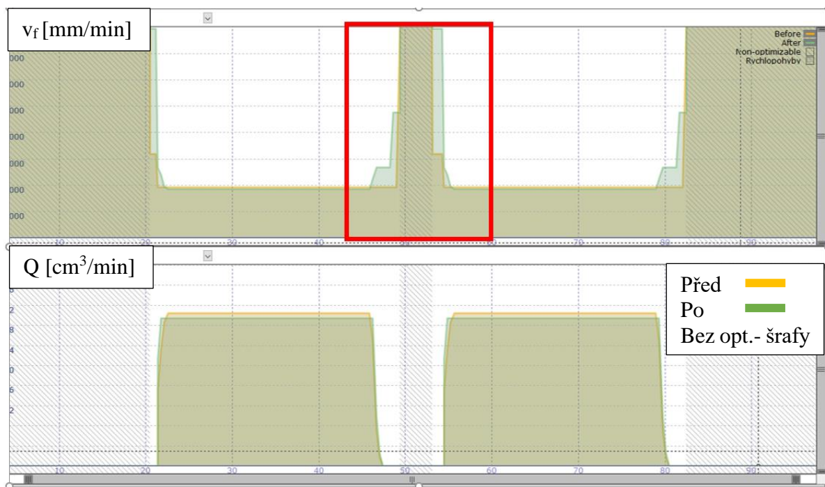
Obr. 42: Graf posuvové rychlosti a objemu odebraného materiálu za jednotku času. Foto autor.
