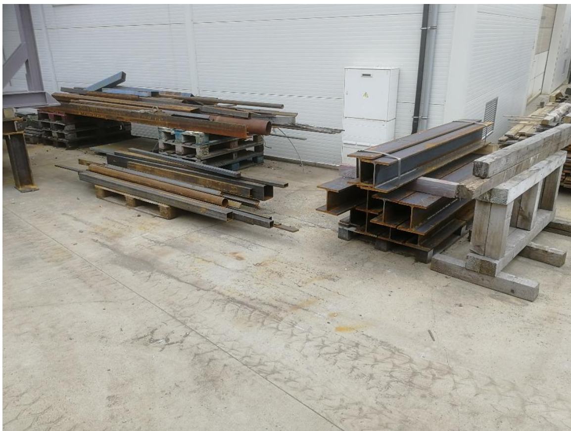
Obrázek 7: Vliv klimatických podmínek na skladování tyčového a jiného materiálu
