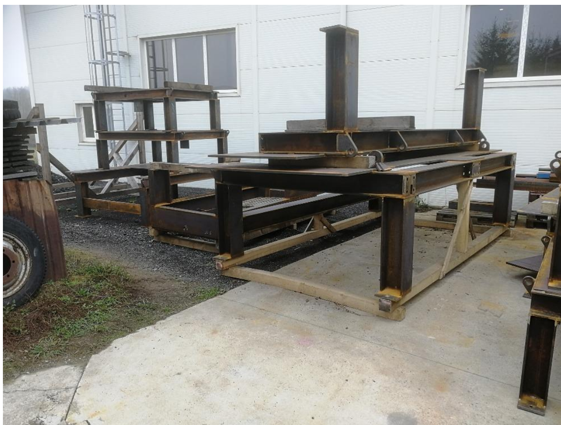
Obrázek 8: Vliv klimatických podmínek na skladování polotovarů určených pro povrchovou úpravu
