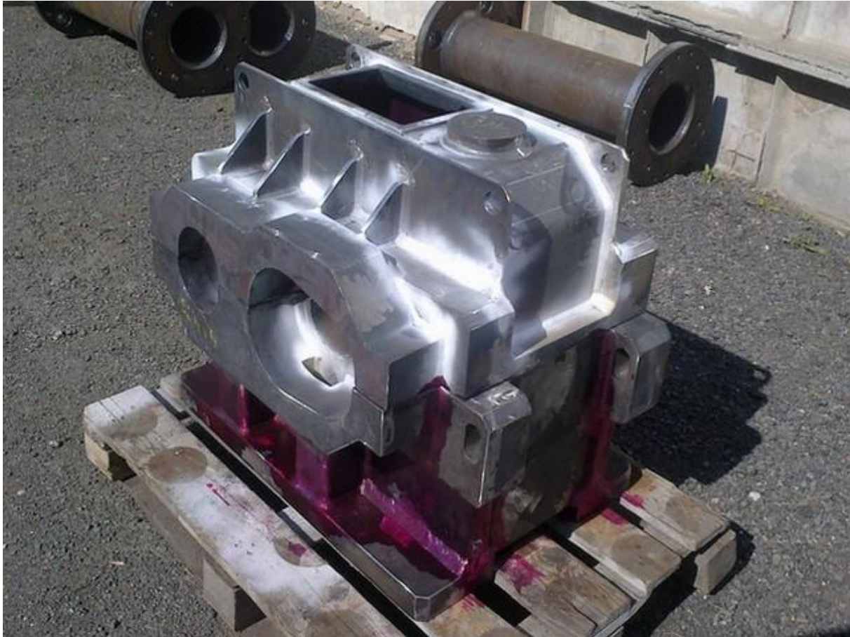
Obrázek 15: Svařená převodová skříň po zkoušce na těsnost svarů [6]
