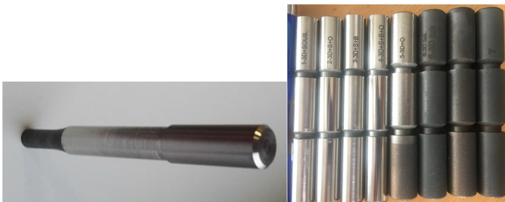
Obrázek 21 Funkční vzorek pro zachování referenčního povrchu [34]
