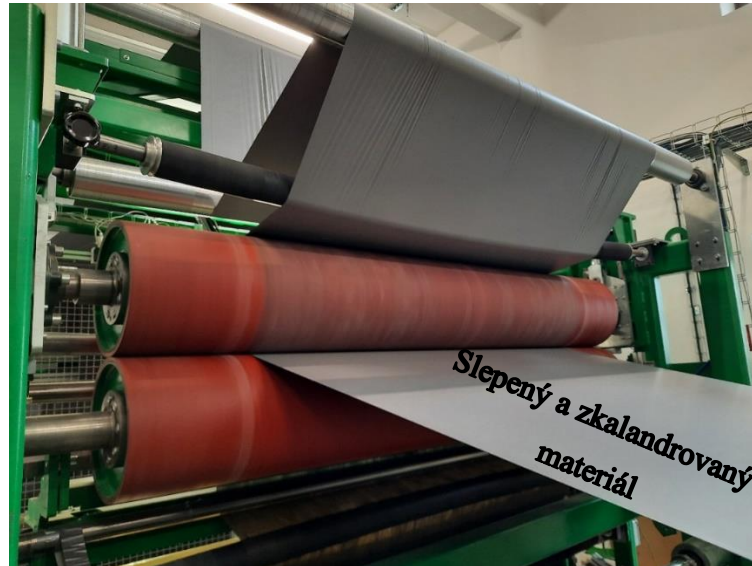
Obr. 18: Slepený a zkalandrovaný materiál
