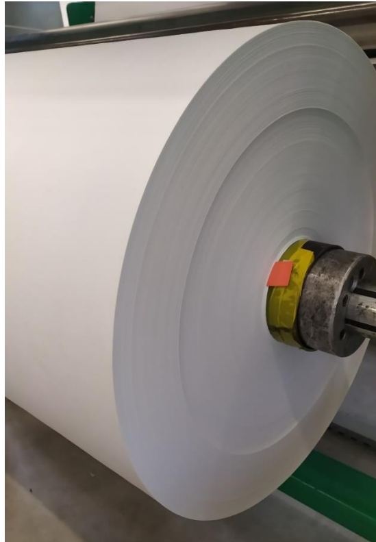
Obr. 26: Špatné zarovnání materiálu
