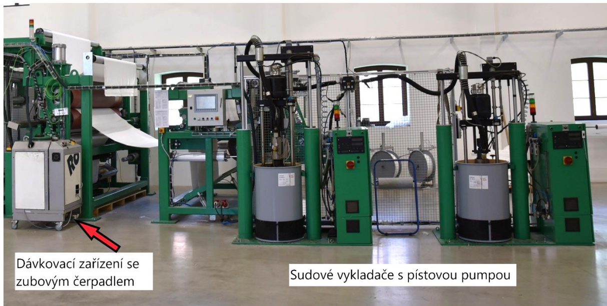
Obr. 21: Tavení a čerpání lepidla
