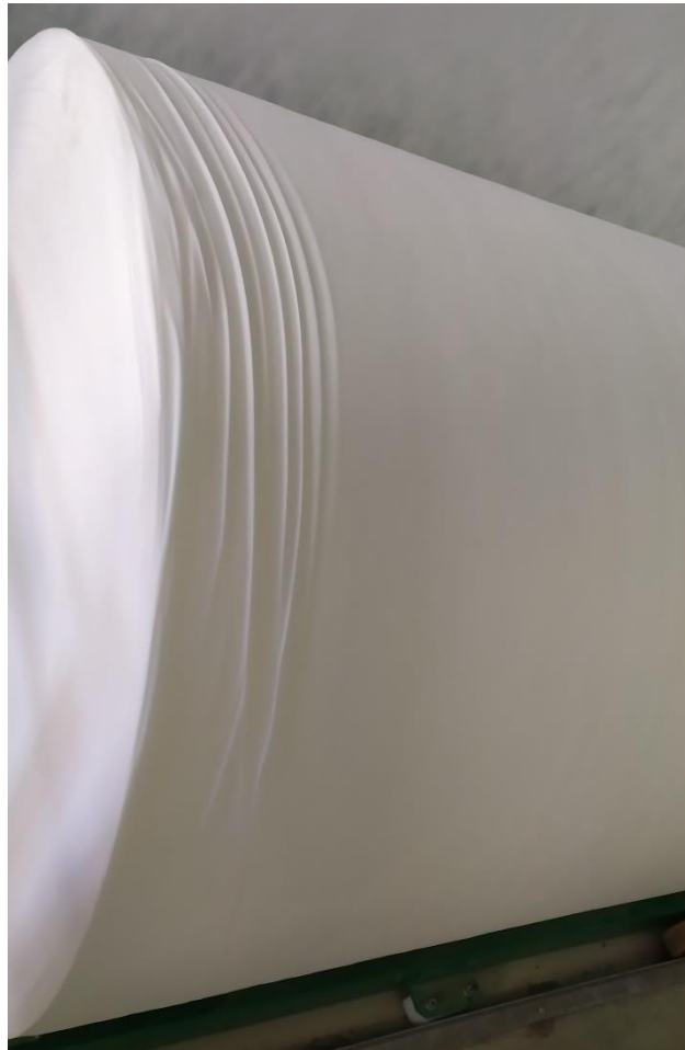
Obr. 24: Nakrčený vstupní materiál
