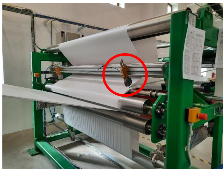
Obr. 19: Systém pro podélné řezání
