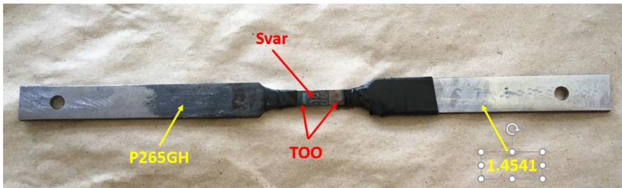
Obr. 21: Hotový vzorek po zkoušce SCC
