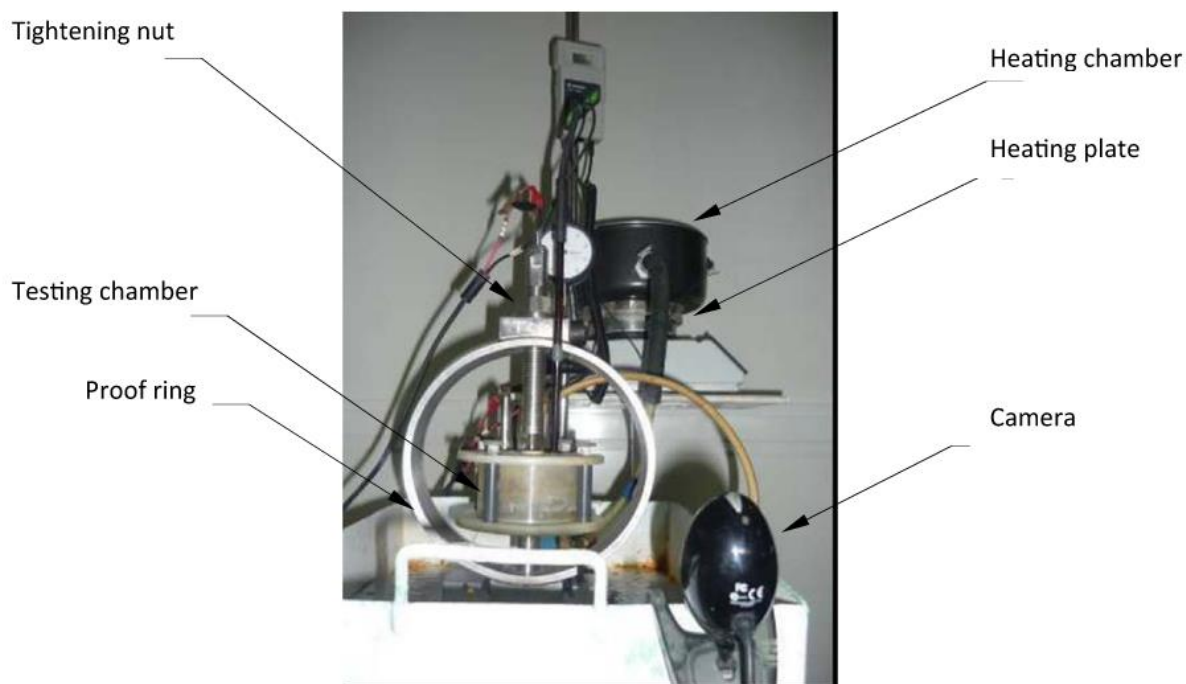
Obr. 7: Výzkumné zařízení pro zkoušení SCC [28]
