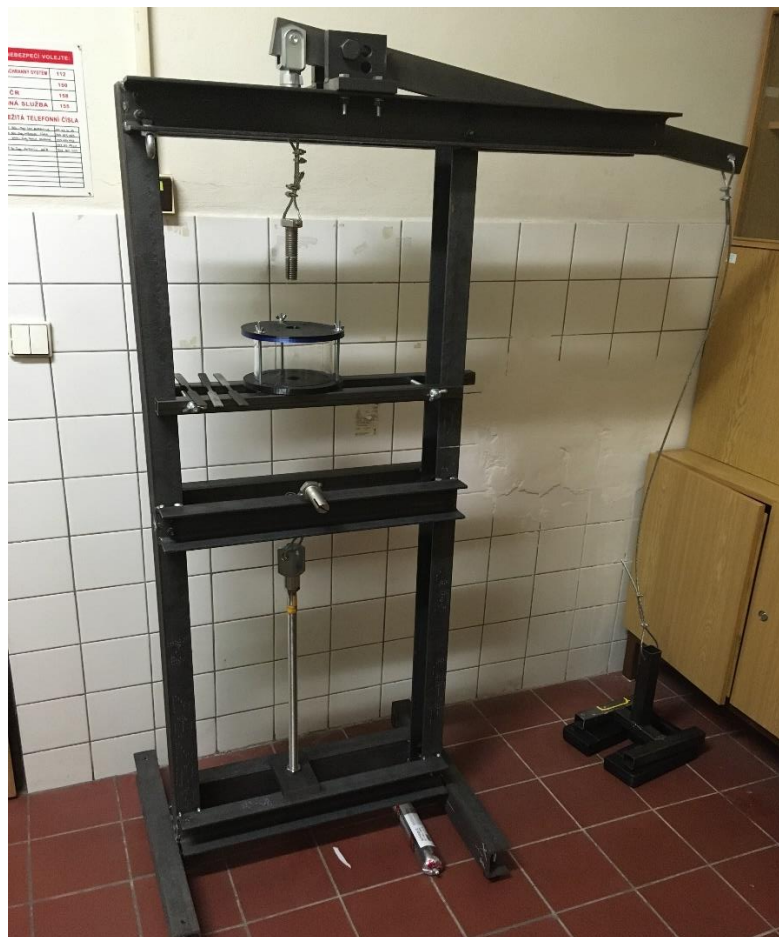
Obr. 10: Tuhý rám včetně závaží a korozní cely
