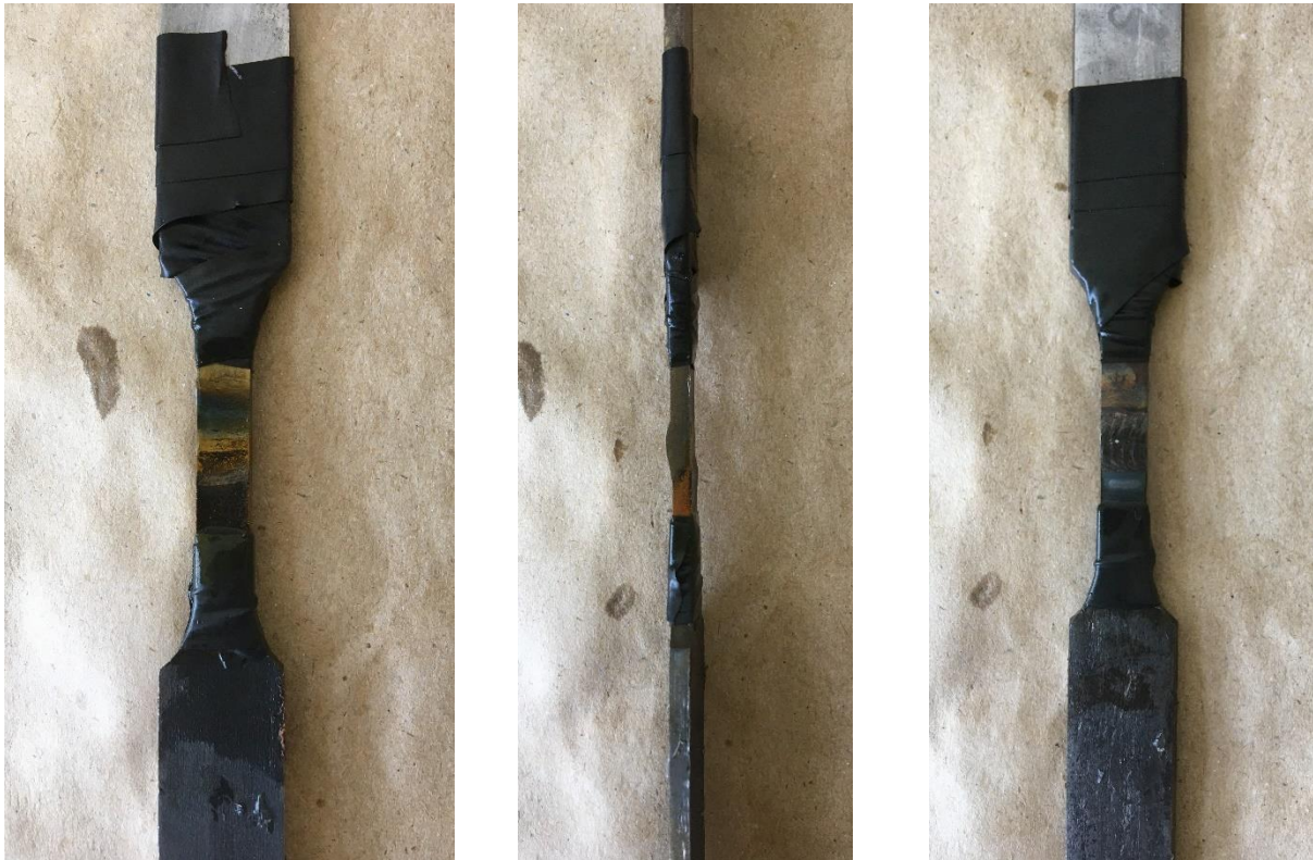
Obr. 24 – 26: Vzorek po hotové zkoušce SCC
