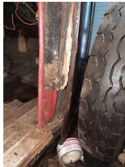
Obr. 36: Chybějící část levého sloupku
