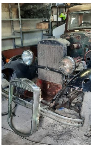
Obr. 30: Demontáž masky chladiče
