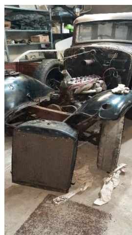
Obr. 31: Demontáž přední části
