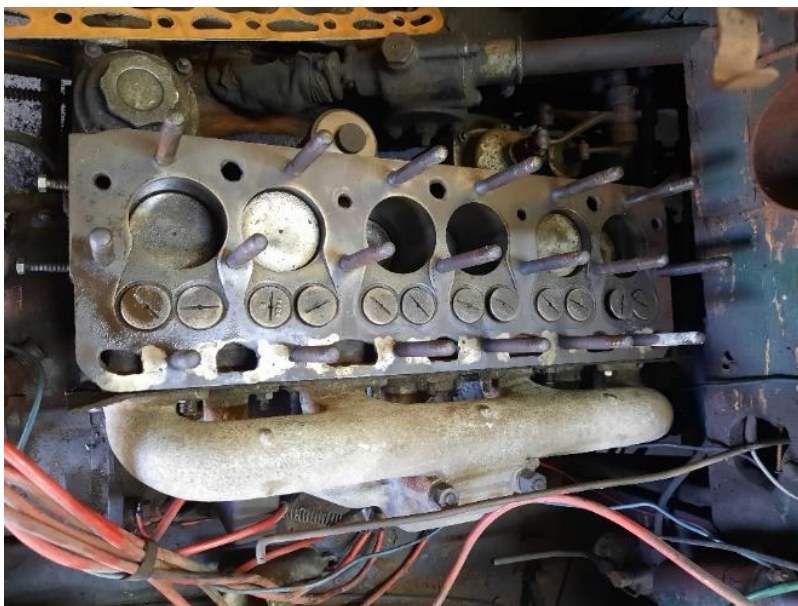
Obr. 44: Silně popraskaný blok renovovaného vozu
