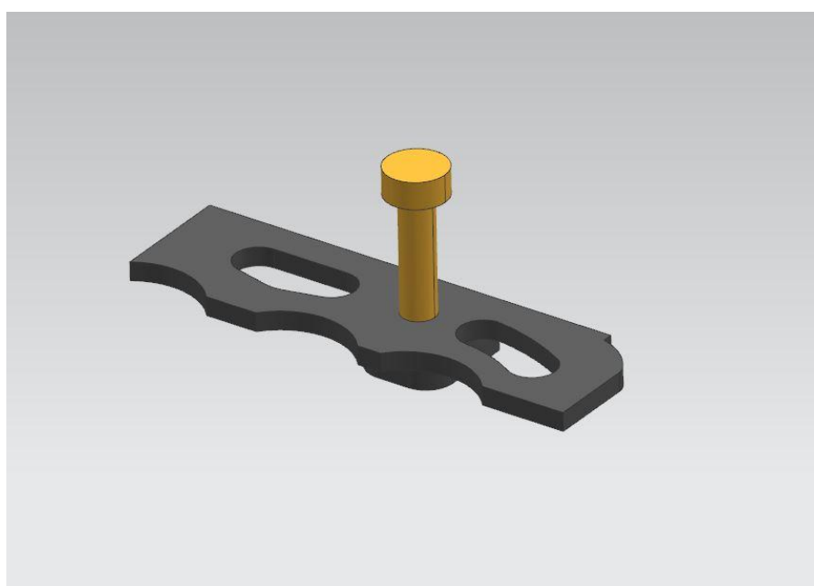
Výřez stěny se závrtným šroubem
