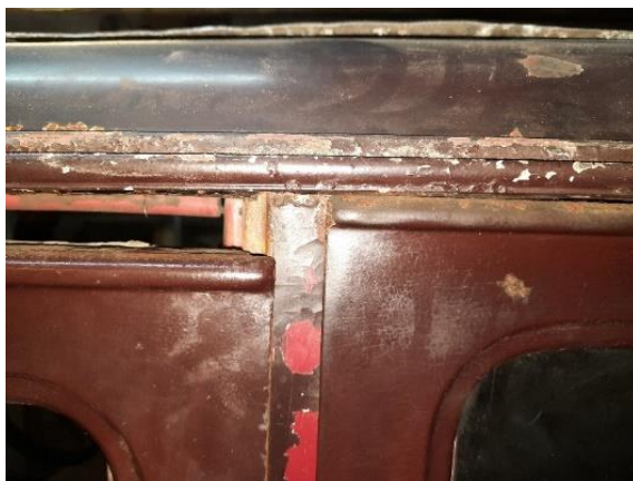
Obr. 32: Prověšené přední dveře
