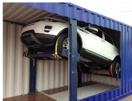
Obr. 30: Automobil zajištěný pomocí R-RAK ⇒ TSB [36]
