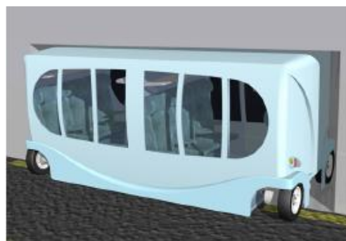
Obr. 21: Přepravní modul velký osobní – najíždění do vlaku [1]
