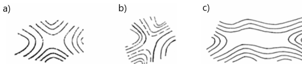
Obr. 3.11: Pravidelné sedlo podélné (a), příčné (b) a nepravidelné sedlo (c) pomocí vrstevnic. Zdroj: [9]
