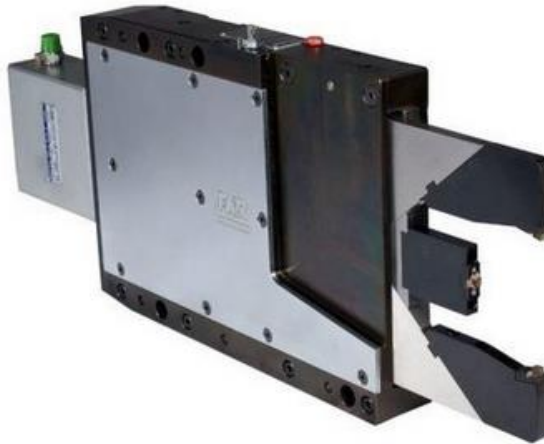
Obrázek 31 úzká samostředící opěra [27]
