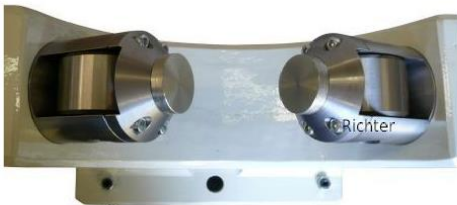
Obrázek 26 Otevřená opěra Richter, s možností kluzného i valivého styku [23]
