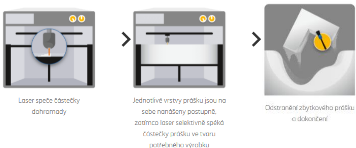
Obr. 4: Schéma průběhu 3D tisku technologií SLS [8]
