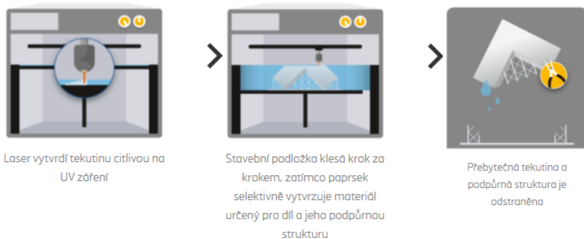
Obr. 3: Schéma průběhu 3D tisku technologií SL [15]
