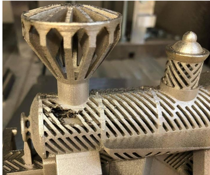
Obr. 71: Vada vzniklá při tisku těla lokomotivy metodou DMLS
