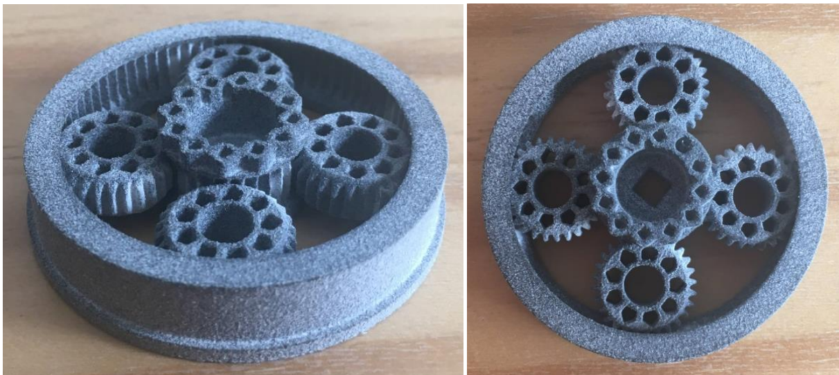
Obr. 68: Výsledek tisku planetové převodovky metodou MJF
