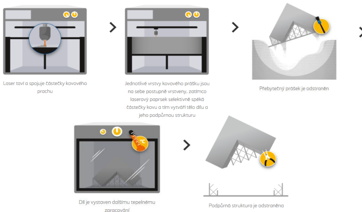
Obr. 5: Schéma průběhu 3D tisku technologií DMLS [16]
