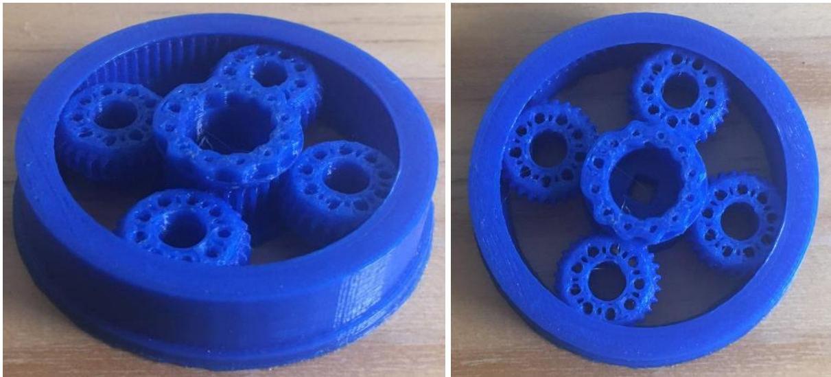
Obr. 66: Výsledek tisku planetové převodovky metodou FDM
