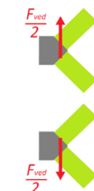
Obr. 144 - Přenesení sil do vedení na vrchní a spodní straně beranu
