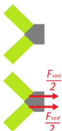
Obr. 143 - Přenesení sil do vedení na vrchní a spodní straně beranu
