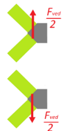
Obr. 144 - Přenesení sil do vedení na vrchní a spodní straně beranu
