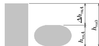
Obr. 24 - Váleček před a po tváření
