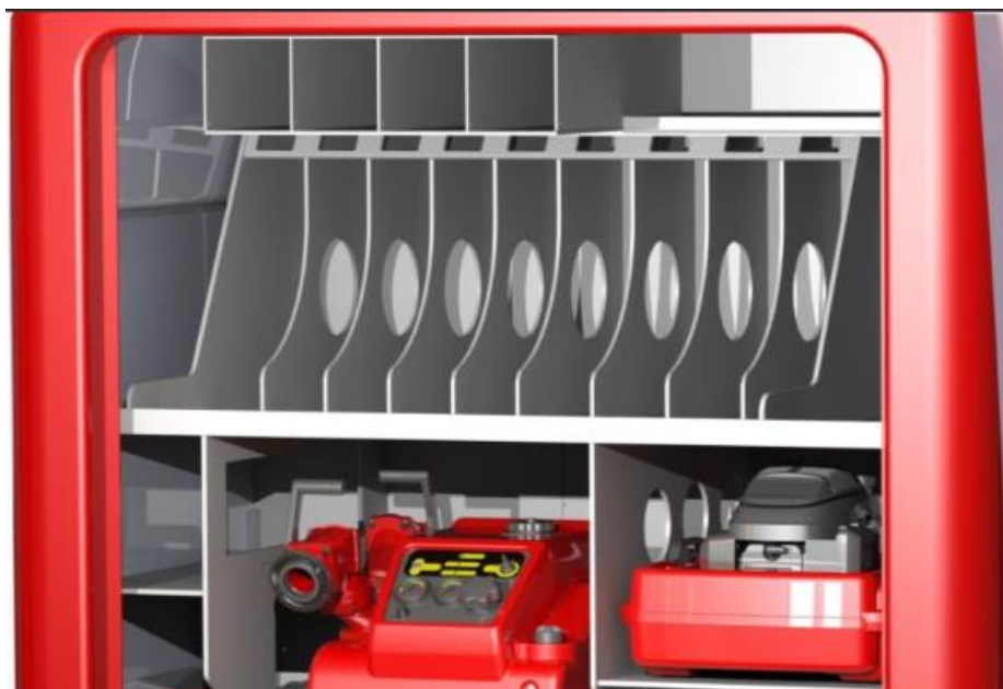
Obr. 41: Nástavba pomocí svařování plastů včetně výztuh firmy ZHT[28]
