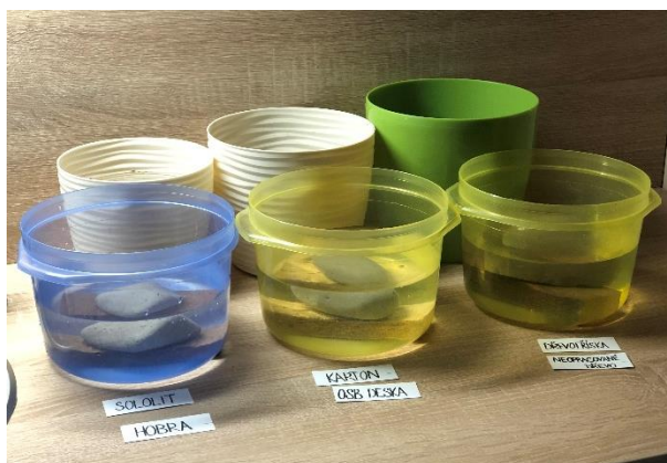
Obrázek 8 - průběh pokusu – Savost
