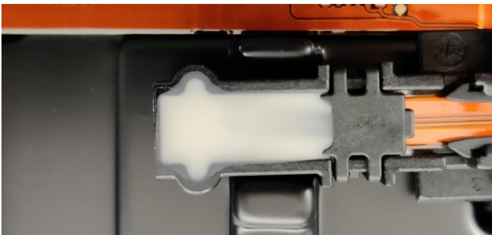
Obrázek 25 Zalítí kusu epoxidovou pryskyřicí
