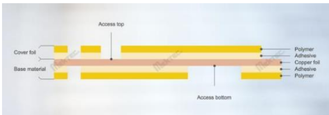
Obrázek 14 Řez flexibilním plošným spojem
