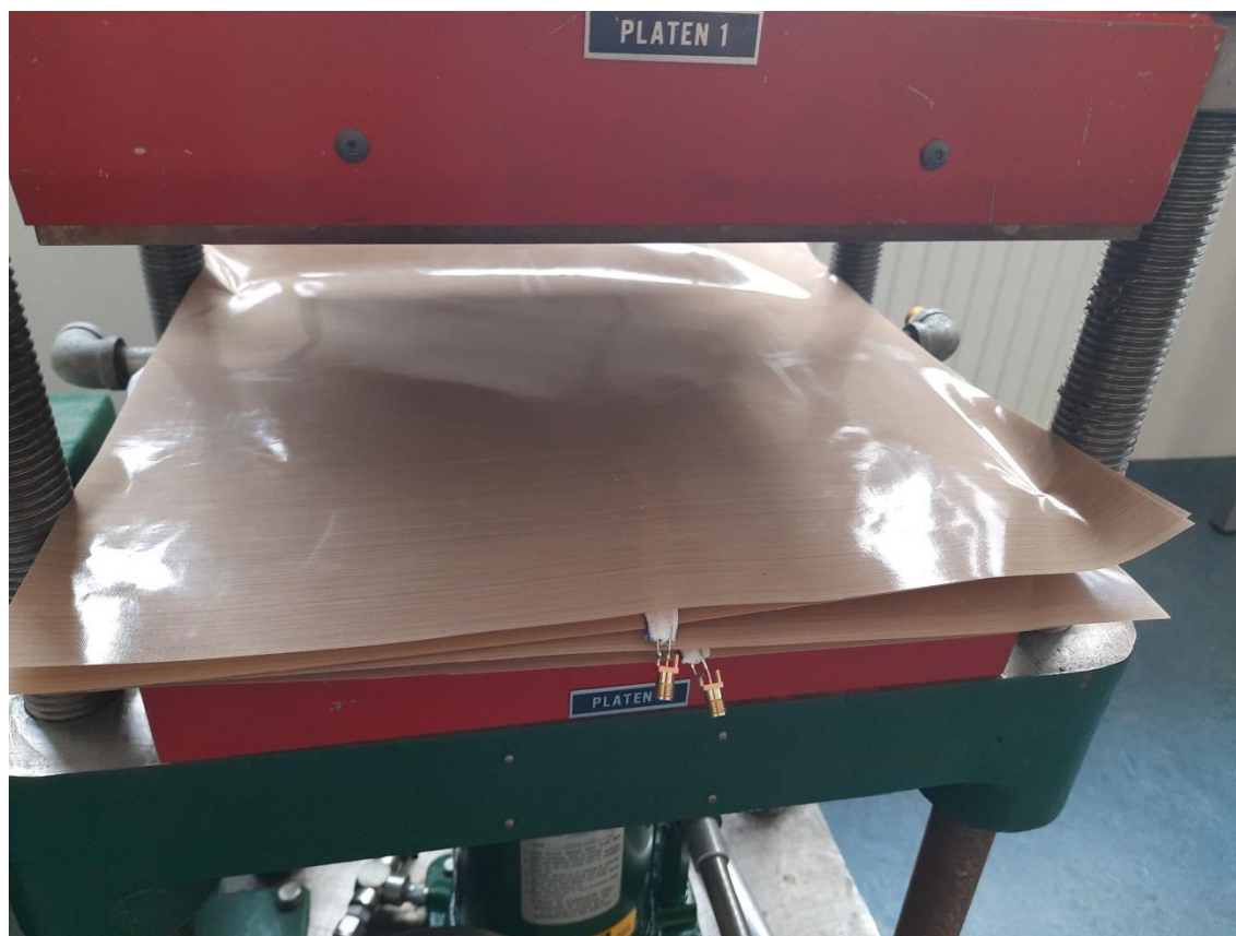
Obr. 17: Uložení vzorků v lisu
