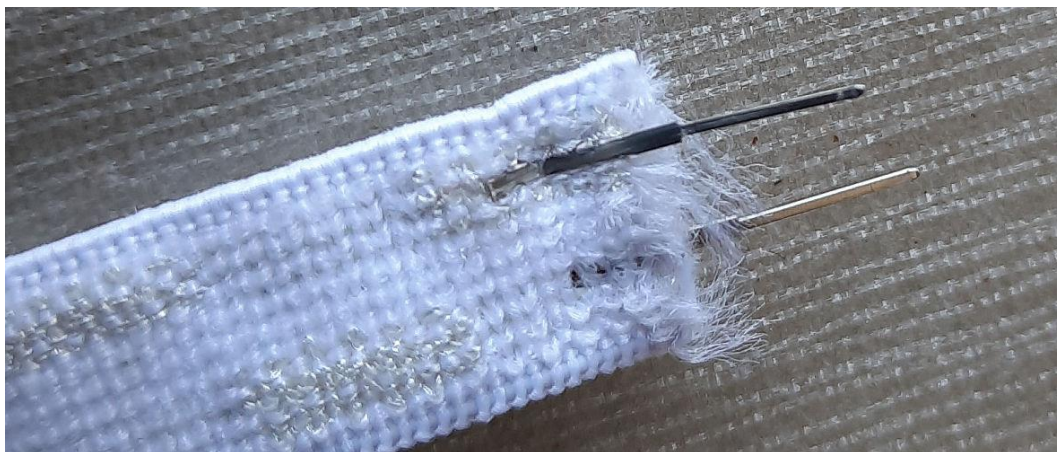
Obr. 14: Piny připevněné na konci stuhy pro pájení SMA konektorů
