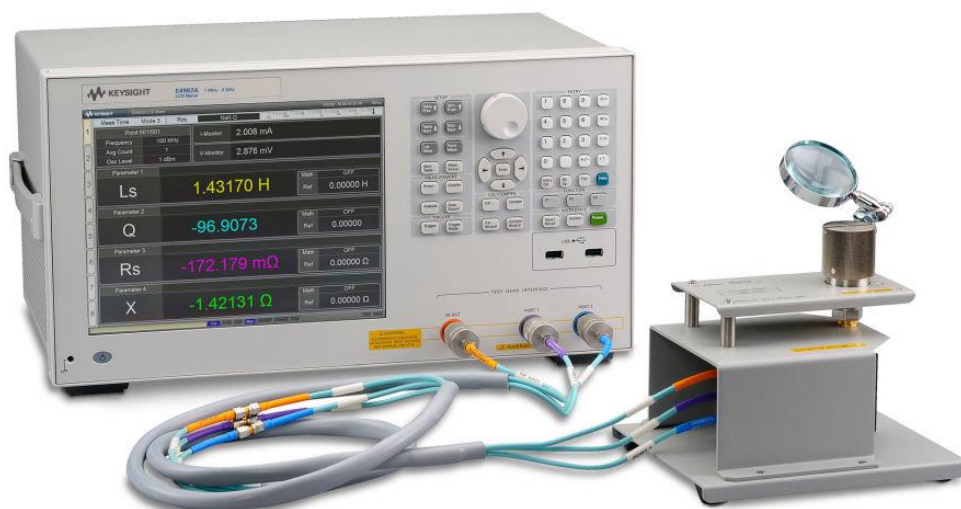
Obr. 5: RLC metr Keysight E4982A (Převzato z [101])
