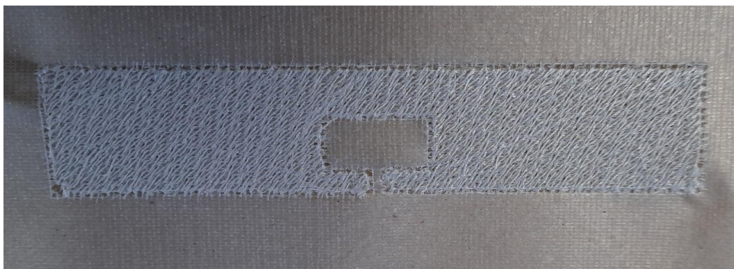
Obr. 12: Detail vyšité antény „c1 stříbro“
