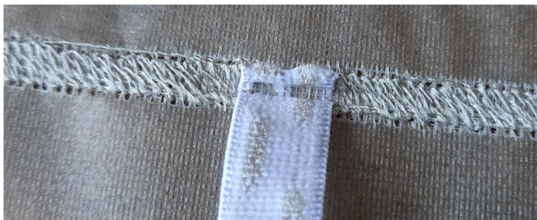
Obr. 13: Odporové přivaření vodivé stuhy k anténě
