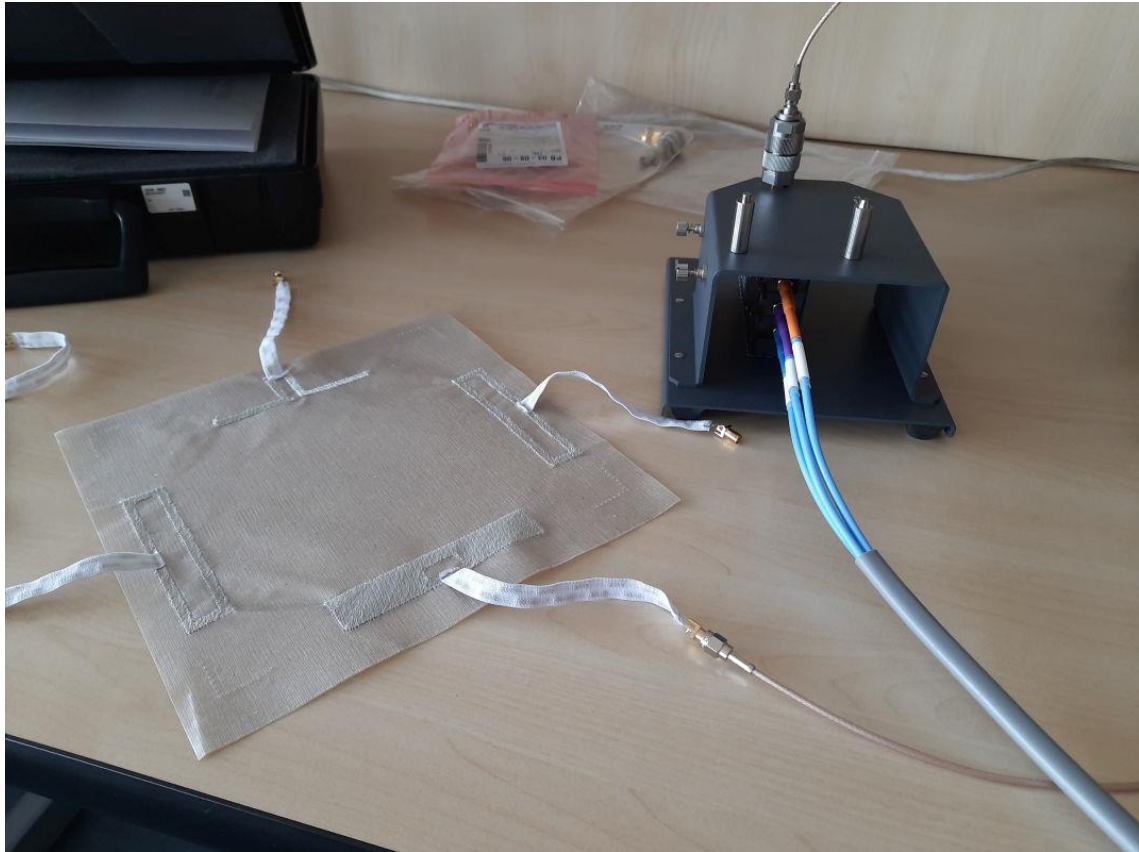
Obr. 20: Připojení vzorku k měřicímu přístroji Keysight E4982A
