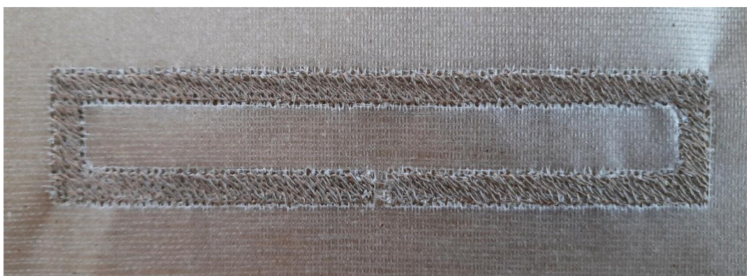
Obr. 11: Detail vyšité antény „c2_1 mosaz“
