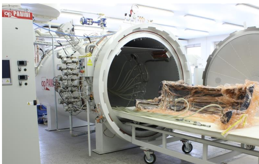
Obr. 5 – Forma s vrstvenými prepregy ve vakuovém pytli ukládána do autoklávu [26]
