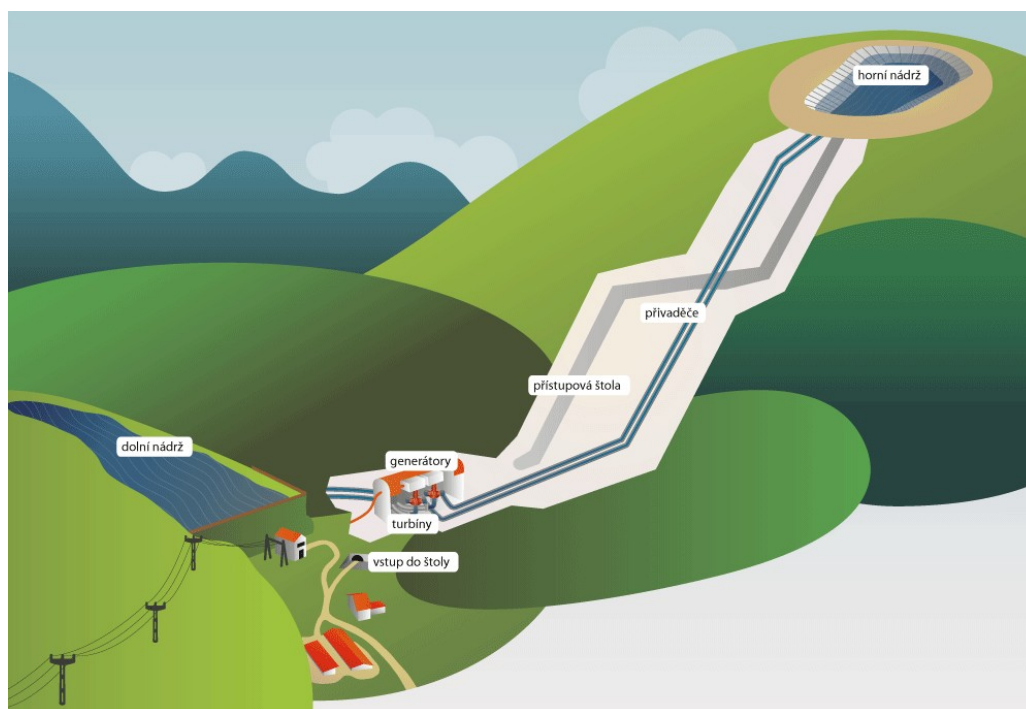
Obrázek 3.2.3. Přečerpávací elektrárna Dlouhé Stráně [35]
