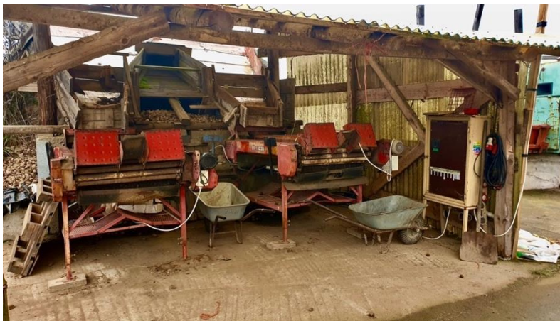
Obr. 1.14 – Přístřešek pro třídíčku brambor a stavební rozváděč
