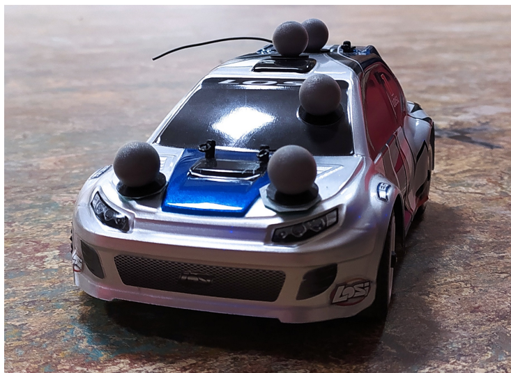
Obrázek 3.1: RC model s Vicon markery
