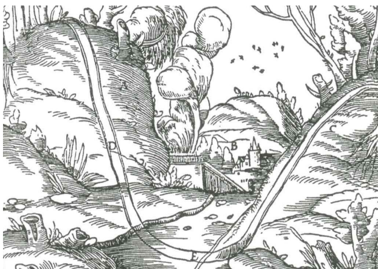
Příloha č. 4: Průběh rudné žíly údolím, vyobrazení z Agricolova díla De re Metallica , libri XII (1556) 438
