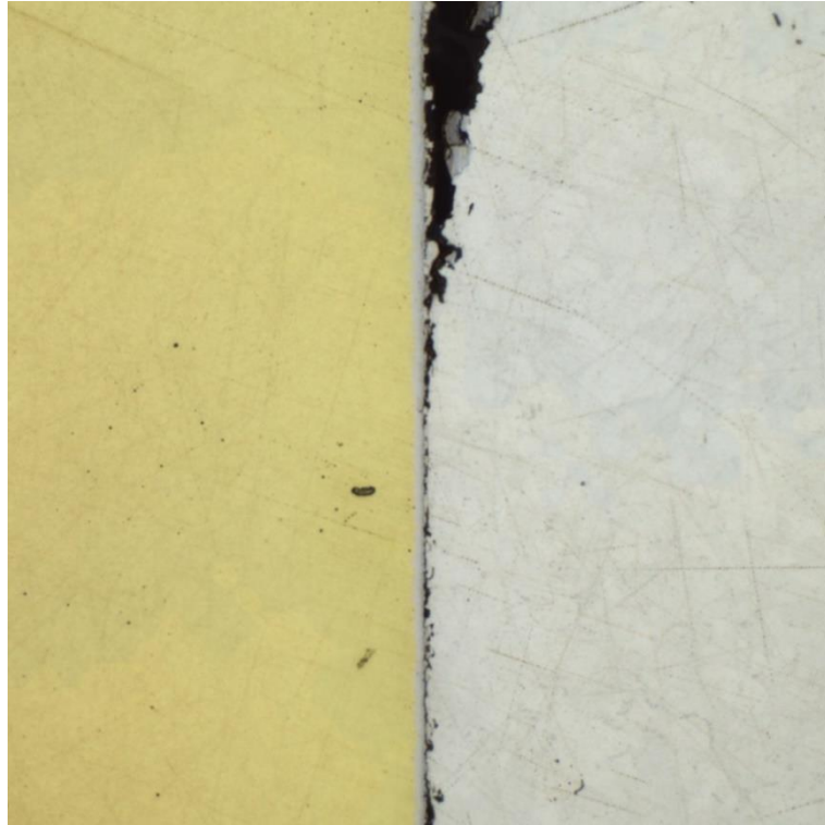
Obrázek 38 Detail praskliny zapájeného pinu
