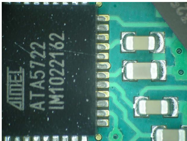
Obrázek 10 Nedostatečně smáčené kontakty na DPS [15]
