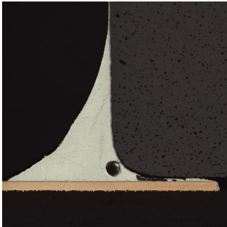
Obrázek 39 Materiálografický výbrus pájeného spoje (intermetalické vrstvy)
