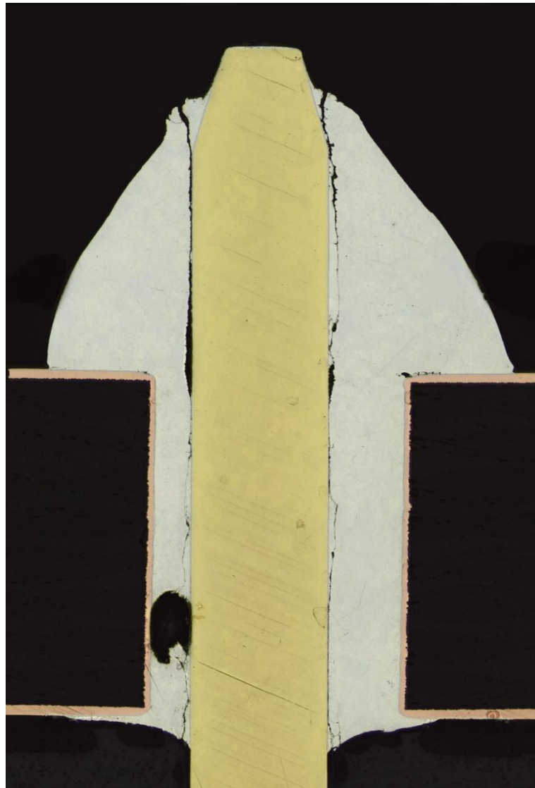
Obrázek 37 Materiálografický výbrus zapájeného pinu
