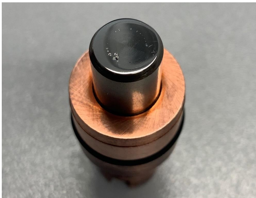
Obrázek 3 Částečně opotřebený terčík z direct trubice
