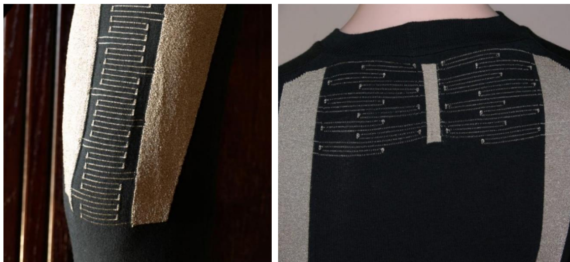
Obr. 29: Vyhříváné textilie WarmX (převzato z [31])
