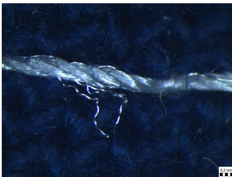
Obr. 57: Snímek místa poruchy na vzorku 4A, zapříčiněné zprětrháním Cu/Ag mikrodrátků hybridní vodivé nitě č. 2
