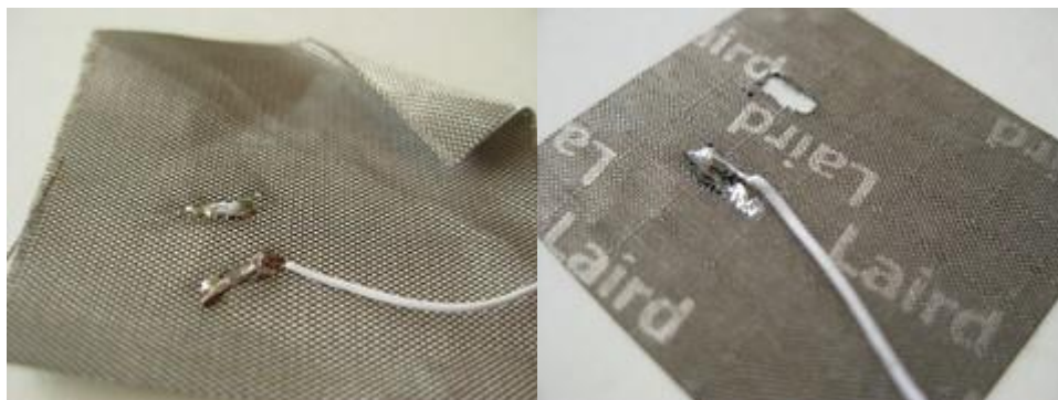
Obr. 12: Pájené kontakty na vodivé textilií (převzato z [17])
