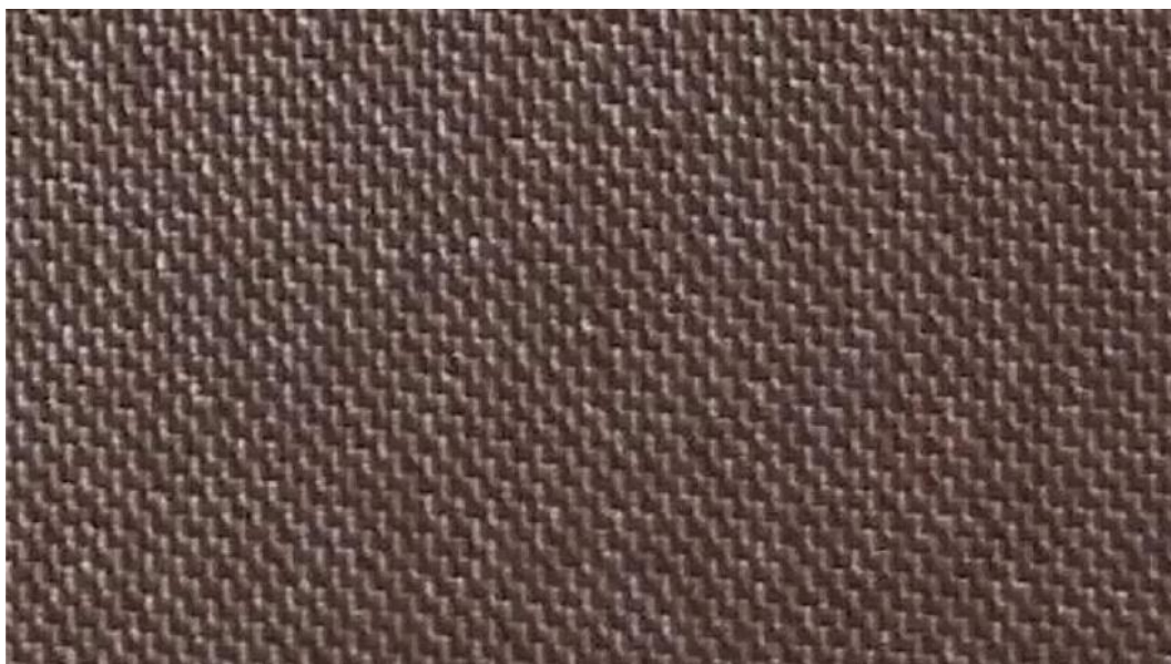
Obr. 22: Tkanina na bázi poměděných polyesterových vláken (převzato z [27])
