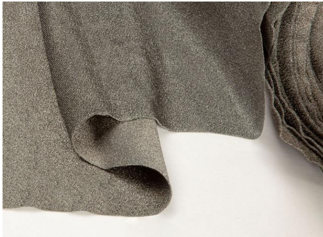
Obr. 7: Pletenina Shieldex® Techniktex P130+B (převzato z [11])
