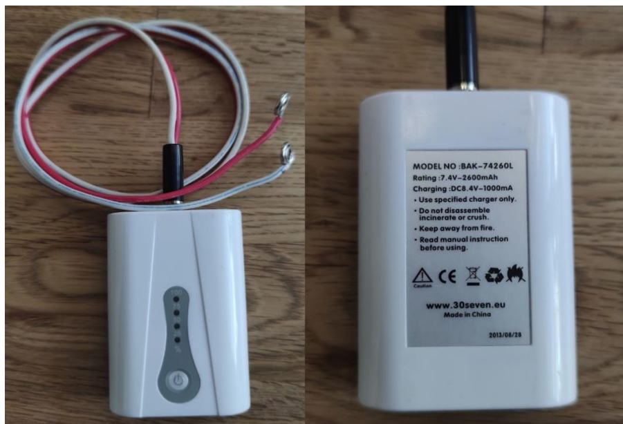
Obr. 34: Li-Ion baterie typ BAK-74260L značky 30seven.
