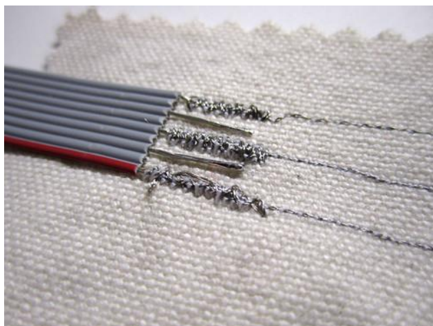
Obr. 15: Přešití odizolovaných vodičů plochého kabelu vodivou nití zig-zag stehem (převzato z [20])
