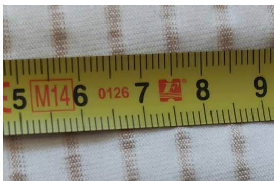
Obr. 35: Detail pletené textilie s vodivými pruhy
