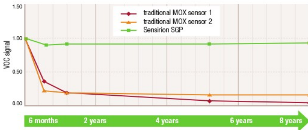
Obr. 2.2. Porovnání stability senzorů SGP a běžných metal-oxidových senzorů
