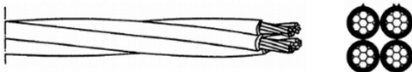
Obr. 2.2 - Vodič AES - čtyřžilové provedení, převzato z [5]
