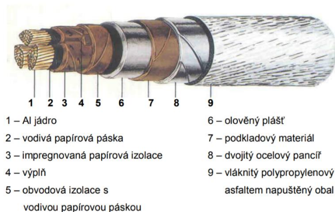
Obr. 11.1 Skladba kabelu s papírovou izolací
